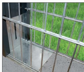
Beim Aufdübeln setzen Sie die Gabione mit den bereits montierten Pfostenhaltern auf den festen Untergrund (Fundament auf Eignung prüfen) und schrauben diese an. Selbstkürzungen nur bis 1430 mm Mattenhöhe.
