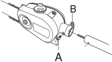
**ACHTUNG!** Darauf achten, dass die Antriebswelle am Führungsrohr genau in die Aussparung am Schneidkopf eingepasst wird.
