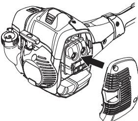
Bestimmte Schalldämpfer sind mit einem speziellen Funkenfangnetz ausgerüstet. Ist Ihr Gerät mit einem derartigen Schalldämpfer ausgestattet, so ist das Netz einmal wöchentlich zu säubern. Dies geschieht am besten mit einer Stahlbürste.
