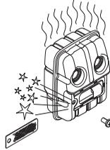
Bei Schalldämpfern ohne Katalysator sollte das Netz einmal in der Woche gereinigt und ggf. ausgetauscht werden. Bei Katalysatorschalldämpfern ist das Netz einmal im Monat zu kontrollieren und evtl. zu reinigen. **Beschädigte Netze sind auszutauschen.**
