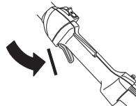
Die Gashebelsperre eindrücken und kontrollieren, ob sie in die Ausgangsstellung zurückkehrt, wenn sie losgelassen wird.
