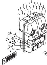
Na dušilcih brez katalizatorja je mrežico za lovljenje isker priporočljivo očistiti in po potrebi zamenjati enkrat na teden. Na dušilcih s katalizatorjem preglejte in očistite mrežico za lovljenje isker enkrat na mesec. **Če je mrežica poškodovana, jo zamenjajte.**
