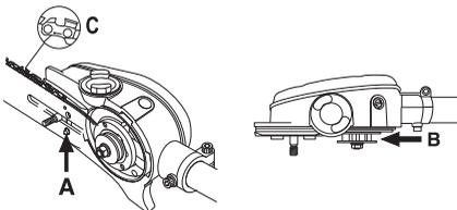
Die Kette durch Schrauben der Kettenspannschraube im Uhrzeigersinn spannen. Den Kombischlüssel benutzen oder von Hand schrauben. Die Kette ist zu
