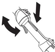
Glej poglavje pod naslovom Vžig. Vžgite stroj in mu dajte polni plin. Izpustite plinsko ročico in se prepričajte, da se rezilni priključek ustavi in obmiruje. Če se rezilni priključek vrti, ko je plinska ročica v legi prostega teka, pregledajte nastavitve uplinjača v prosti legi. Glejte navodila v poglavju Vzdrževanje.
