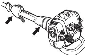
Sistem za dušenje vibracij ublaži tresljaje, ki se z motorja in verige prenašajo na ročaja stroja.
