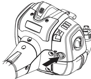
**Choke:** Den Chokehebel in Choke-Lage führen.
