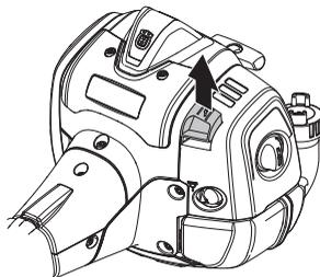
Razstavite ohišje zračnega filtra in izvlecite filter. Očistite ga s stisnjenim zrakom.
