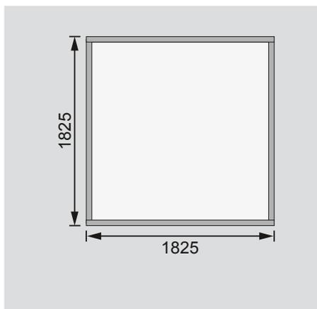
Fundamentplan mit Boden (in mm)
