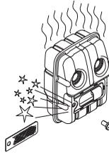
Na dušilcih brez katalizatorja je mrežico za lovljenje isker priporočljivo očistiti in po potrebi zamenjati enkrat na teden. Na dušilcih s katalizatorjem preglejte in očistite mrežico za lovljenje isker enkrat na mesec. **Če je mrežica poškodovana, jo zamenjate.**
