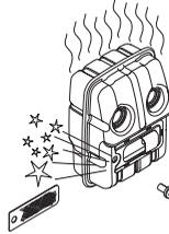
Bei Schalldämpfern ohne Katalysator sollte das Netz einmal in der Woche gereinigt und ggf. ausgetauscht werden. Bei Katalysatorschalldämpfern ist das Netz einmal im Monat zu kontrollieren und evtl. zu reinigen. **Beschädigte Netze sind auszutauschen.**
