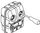
Ist der Schalldämpfer Ihres Gerätes mit einem Funkenfangnetz versehen, muss dieses regelmäßig gereinigt werden. Ein verstopftes Netz verursacht ein Heißlaufen des Motors mit schweren Motorschäden als Folge.
