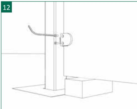
12 | Die Befestigung und Klemmung der Elemente erfolgt durch Aufschauben des Grundkörpers mit je zwei Innensechskantschrauben auf die Klemmplatte.
