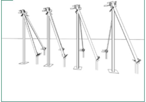
4 | Fertig- oder Estrichbeton in erdfeuchtem Zustand in die Erdlöcher füllen. Den Beton mit einem Kantholz verdichten! Zwischendurch immer wieder den korrekten Stand der Pfosten kontrollieren! Abschließend verbliebende Betonreste mit etwas Wasser von den Pfosten entfernen! Den Beton laut Packungsangabe (mind. 24 Std.) abbinden lassen. Die Pfosten bis zum Abbinden des Betons abstützen.
