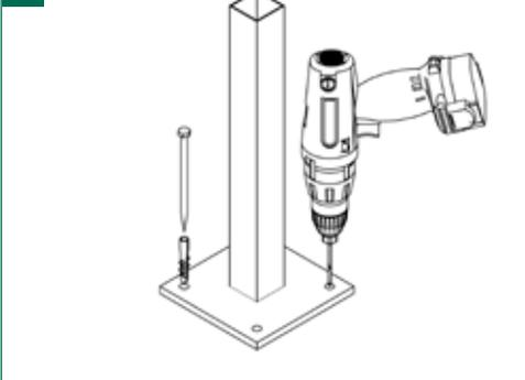
5 | Alternativ können bei bauseits vorhandenem Betonfundament oder Mauersockel Konsolen zum Aufschrauben Verwendung finden. Diese werden vom Maß her identisch wie beim Betonieren ausgerichtet und mit einer geeigneten Schrauben-/Dübelkombination befestigt.
