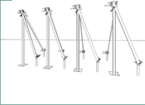
3 | Die Pfosten mit Holzleisten und Schraubzwingen zum nachfolgenden Einbetonieren abstützen. Zwischen Schraubzwinge und Kunststoffoberfläche kleine Hölzer legen, um Kratzer zu vermeiden! Nochmalige Kontrolle des korrekten Pfostenabstands und der senkrechten Ausrichtung!
