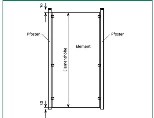
Die Pfostenhöhe ergibt sich wie folgt: 30 mm Bodenabstand zum Element + Elementhöhe + 70 mm Pfostenüberstand (oberhalb des Sichtschutzelements; siehe Zeichnung). Der Aluminiumpfosten zum Einbetonieren ist ca. 500 mm länger, um diesen im Erdreich festzusetzen.
