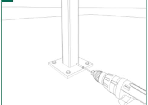
6 | Die Pfosten anschließend über die Konsolen stecken und mit zwei gegenüberliegenden Blechschrauben, die quer am unteren Pfostenrand eingeschraubt werden, sichern. Wir empfehlen die Löcher mit einem Metallbohrer vorzubohren.
