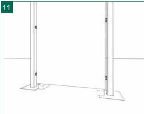
11 | Nach der Befestigung der Klemmplatten die Elemente montieren. Hierbei ist Vorsicht geboten - **Bruchgefahr!** Zur Absicherung des Elements zwei 30 mm starke Hölzer unterlegen!
