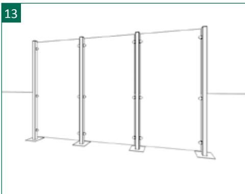
13 | Nach der Montage der Elemente werden nun noch die Holzunterlagen entfernt und die Pfostenkappen aufgeschoben - Fertig!
