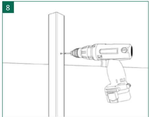
8 | Mit einem Metallbohrer an den Markierungen Löcher mit einem Durchmesser von  $\varnothing$  5,5 mm bohren.
