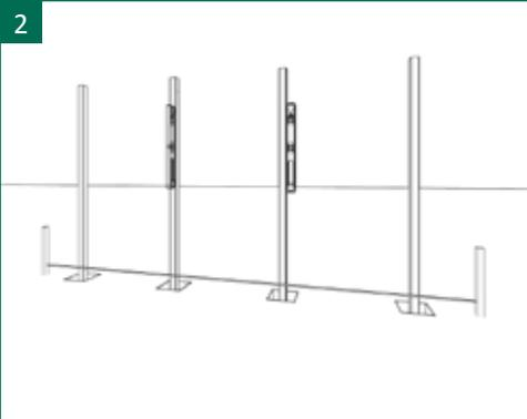
2 | Die Pfosten in die Fundamentlöcher setzen und mit einer Wasserwaage ausrichten (von zwei Seiten, 90° versetzt). Die Pfosten so einrichten, dass bei dem „Typ Senkrecht“ und dem „Typ Schräg“ ein Abstand von 936 mm zwischen den beiden Innenseiten der Pfosten eingehalten wird. Der Abstand für den „Typ Waagerecht“ beträgt 1836 mm zwischen den Pfosten. Die Oberkanten der Pfosten mit der Wasserwaage auf die gleiche Höhe ausrichten.
