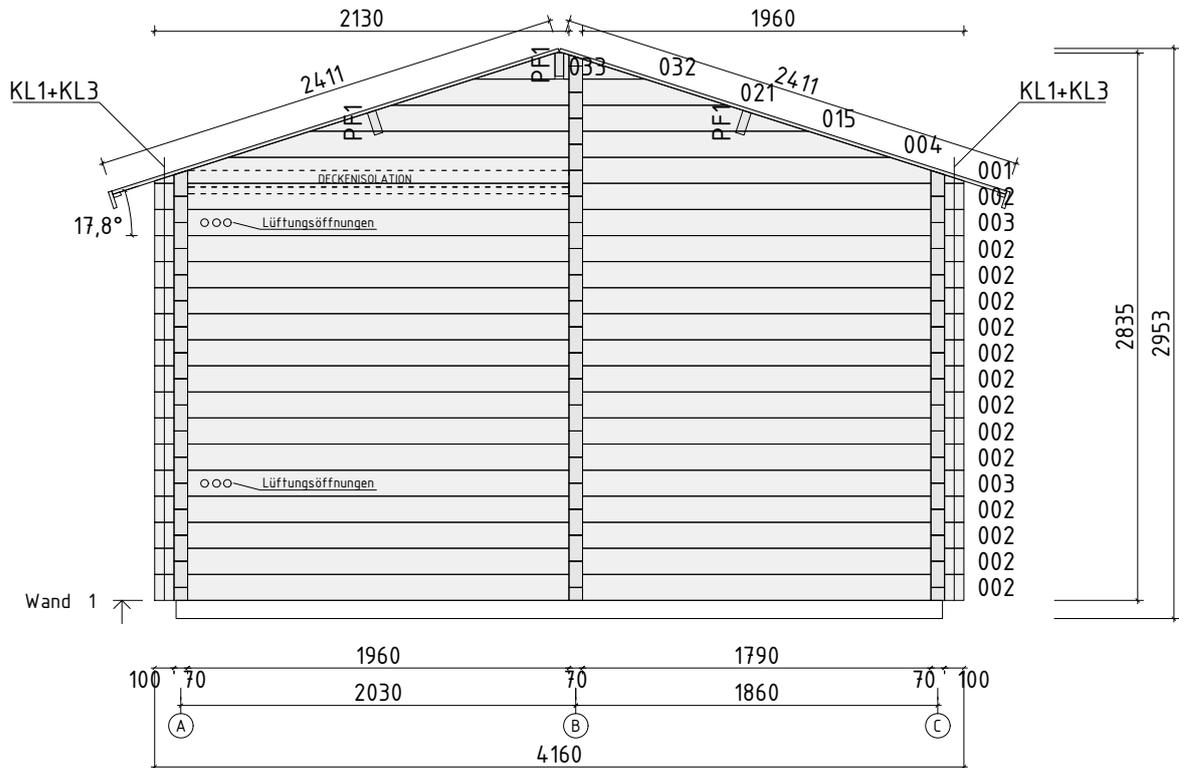
Die Bohlen mit Lüftungsöffnungen können je nach Bedarf höher oder niedriger eingesetzt werden. Bitte achten Sie darauf dass die Lüftungsöffnungen von innen nicht mit der Saunabank bedeckt werden!
