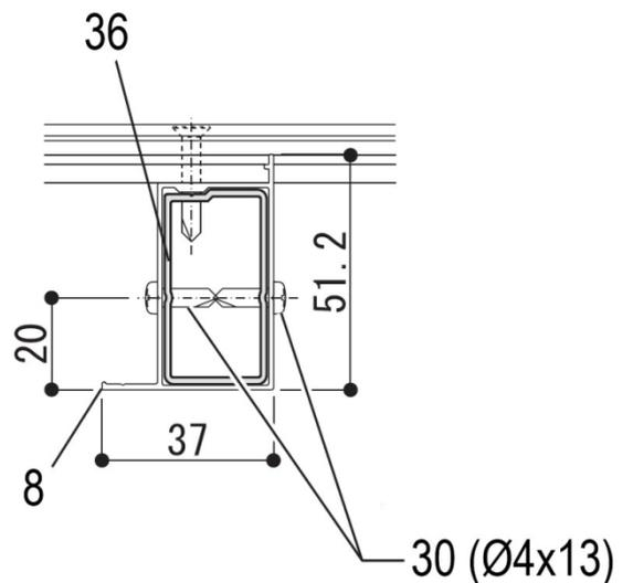
**Verbindung Hinteres Längsprofil:**
