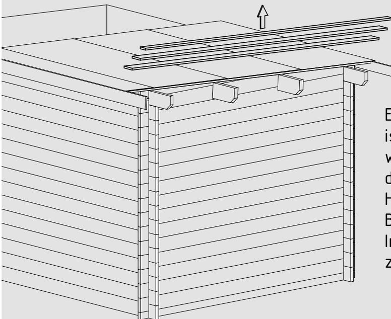
Entfernen der Dachbretter ist nicht unbedingt nötig, wenn genug Platz da ist um das neue Dach zu montieren. Hier entfernen wir die Bretter um den Installationsvorgang sichtbar zu machen.
