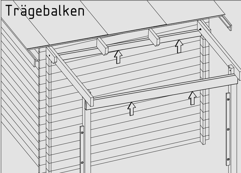
Die Trägebalken von unten an die Dachpfetten drücken. Bitte beachten dass die Pfosten gerade bleiben.
