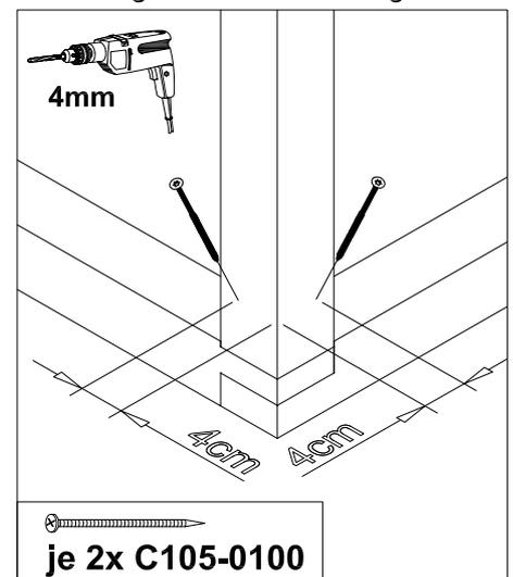
Stellen Sie nun die einzelnen Wände auf und verschrauben Sie die ausgeblatteten Schwellen mit 2x C105-0050 miteinander. Dann stellen Sie die restlichen 3 Eckpfosten auf und verschrauben sie nach dem Vorbohren mit 2x C105-0100 seitlich von oben mit der Schwelle. Um eine Kollision der Schrauben des Grundgerüsts und der Fassadenplatten zu vermeiden setzen Sie die Schrauben 4cm von der Außenkante.
