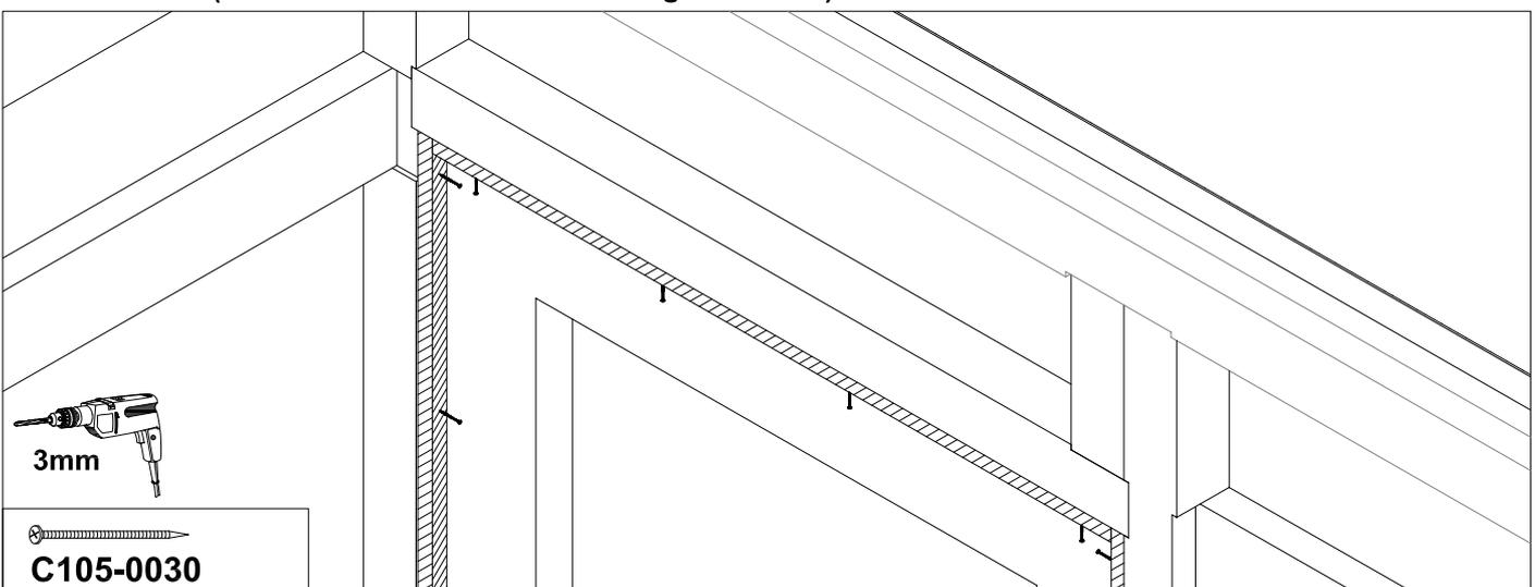
Bringen Sie nun die seitlichen Blendeleisten so an, daß der die Holzaußenseite des Türrahmens mit der Außenkante der Holzkonstruktion bündig ist. Verschrauben Sie nun die seitlichen Leisten mit je 6x C105-0030 von innen mit den Pfosten bzw. die obere mit 4x C105-0030 von unten mit dem Türsturz. Behalten Sie einen Abstand von ca. 4cm zum Ende der Leiste.
