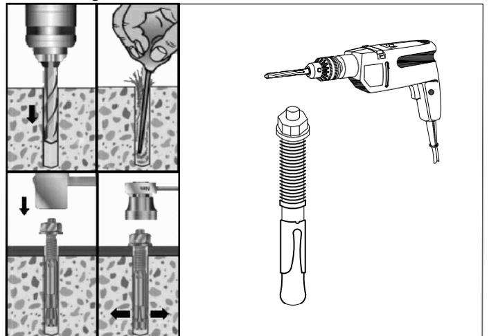
Befestigen Sie nun die Schwellen, ausser die der Frontseite, alle 60cm mit Hilfe von Schwerlastdübeln am Fundament. **(Dübel sind nicht im Lieferumfang enthalten!)**
