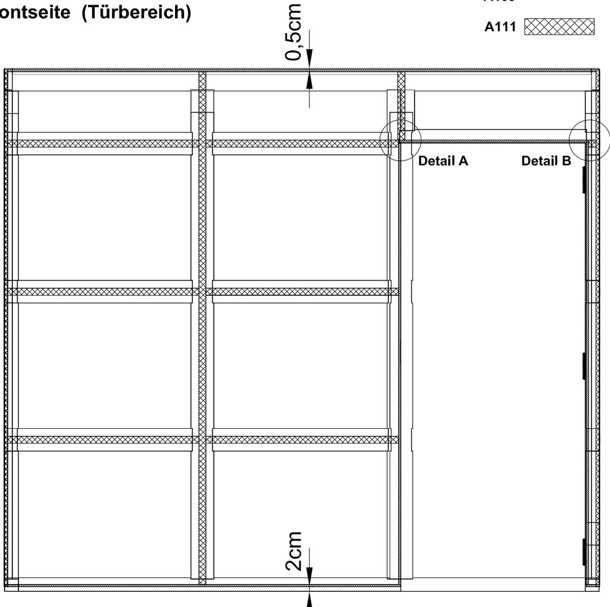
Beginnen Sie mit dem unteren Dichtband (A109) 2cm von der Unterkante des Gebäudes, von der Oberkante halten Sie 0,5cm Abstand.
