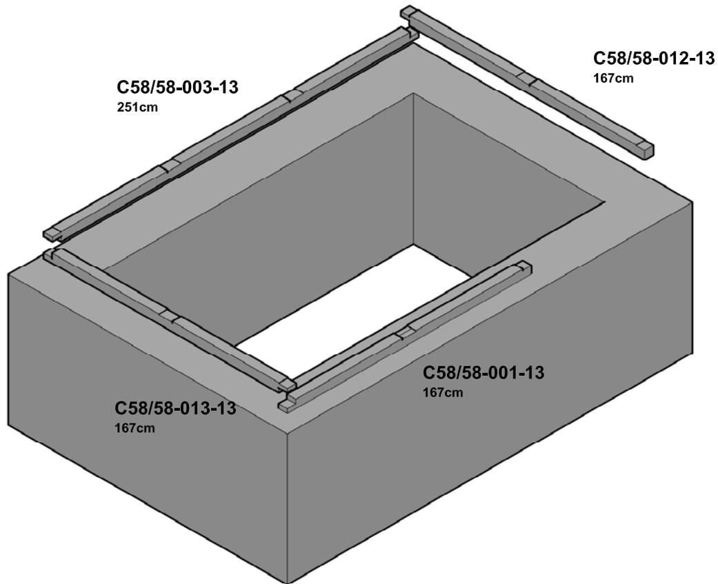
Legen Sie die Schwellen entsprechend auf dem Fundament bereit aber befestigen Sie diese noch nicht, um die Möglichkeit zu behalten das Gerüst bis zum Anbringen der Fassadenplatten noch auszurichten.
