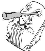
Bestimmte Schalldämpfer sind mit einem speziellen Funkenfangnetz ausgerüstet. Ist Ihr Gerät mit einem derartigen Schalldämpfer ausgestattet, so ist das Netz einmal wöchentlich zu säubern. Dies geschieht am besten mit einer Stahlbürste. Bei Verstopfung des Netzes läuft der Motor heiß, was schwere Motorschäden zur Folge haben kann.
