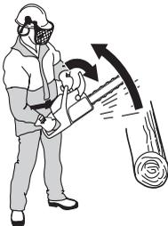
Bei weniger kräftigen Rückschlägen oder wenn sich der Rückschlagbereich in der Nähe des Anwenders befindet, wird die Kettenbremse mit der linken Hand manuell betätigt.
