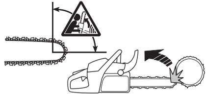
Ein Rückschlag ist immer in Richtung der Führungsschiene gerichtet. Am häufigsten erfolgt der Stoß von Motorsäge und Führungsschiene nach oben und nach hinten zum Anwender. Rückschläge erfolgen aber auch in andere Richtungen, je nachdem in welcher Stellung sich die Motorsäge in dem Augenblick befindet, in dem der Rückschlagbereich mit einem Gegenstand in Berührung kommt.
