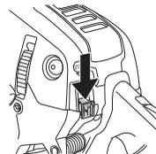
**ACHTUNG!** Der Start/Stoppschalter geht automatisch in die Betriebsposition zurück. Um ein ungewolltes Starten zu vermeiden, muss bei einer unbeaufsichtigten Maschine stets die Zündkappe von der Zündkerze entfernt werden.
