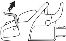
Die Säge niemals am Bremsbügel tragen oder aufhängen! Dadurch kann der Mechanismus
