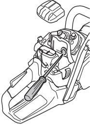
Bei Temperaturen unter  $-5\text{ }^{\circ}\text{C}$  und/oder Schnee kann auf dem Startvorrichtungengehäuse eine spezielle Abdeckung montiert werden.
