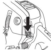
**ACHTUNG!** Der Start/Stopschalter geht automatisch in die Betriebsposition zurück. Um ein ungewolltes Starten zu vermeiden, muss bei Montage, Kontrolle und/oder Wartung daher stets die Zündkappe von der Zündkerze entfernt werden.
