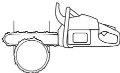
Es gibt Methoden zum Fällen von Bäumen, deren Stammdurchmesser größer ist als die Führungsschielenlänge. Bei solchen Methoden besteht große Gefahr, dass der Rückschlagbereich der
