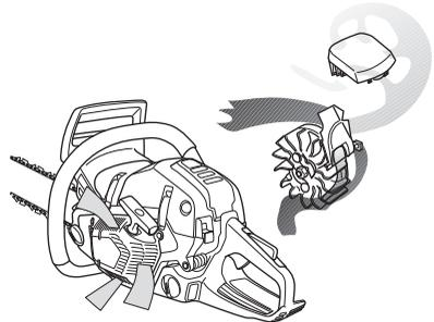
WICHTIG! Um die Funktion der Zentrifugalreinigung aufrecht zu erhalten, muss diese regelmäßig gewartet und gepflegt werden. Den Lufteinlass der Startvorrichtung, die Gebläseflügel des Schwungrads, den Raum um das Schwungrad, das Ansaugrohr und den Vergaserraum reinigen.
