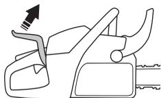
Žage ne nosite ali obešajte za sprožilec! Lahko poškodujete mehanizem in onemogočite zavoro verige.
