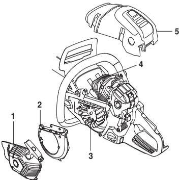
Das Kühlsystem einmal pro Woche mit einer Bürste reinigen, bei schwierigen Verhältnissen öfter. Eine Verschmutzung oder Verstopfung des Kühlsystems führt zur Überhitzung des Gerätes, die Schäden an Zylinder und Kolben zur Folge haben kann.
