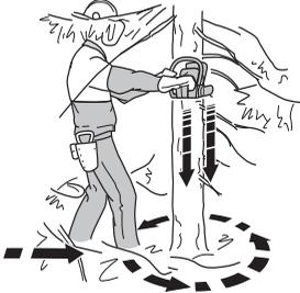
Unterholz rund um den Baum entfernen und auf evtl. Hindernisse achten (Steine, Äste, Löcher usw.), so dass ein leichter Rückzugsweg gesichert ist, wenn der Baum zu fallen beginnt. Der Rückzugsweg sollte etwa 135° schräg hinter der geplanten Fällrichtung des Baumes liegen.
