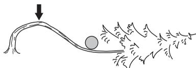
Ocenite, kako je napetost mogoče sprostiti na najbolj varen način in če boste tej nalogi lahko kos osebno. V zapletenih primerih je možen en sam varen način dela: odložite motorno žago in uporabite vitel.
