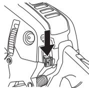
**PAZITE!** Stikalo za zagon/zaustavitev se samodejno povrne v začetni položaj. Da bi preprečili neželeni zagon morate zaganjalno varovalko odstraniti iz svečke, ko stroj ni nadzorovan.
