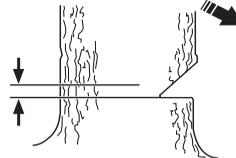
Die Rindenstütze (falls montiert) hinter dem Brechmaß ansetzen. Mit Vollgas sägen und mit der Sägekette/ Führungsschiene langsam in den Baumstamm schneiden. Aufpassen, ob sich der Baumstamm entgegengesetzt zur Fällrichtung bewegt. Einen Fällkeil oder einen Fällheber in den Fällschnitt schieben, sobald die Schnitttiefe dies gestattet.
