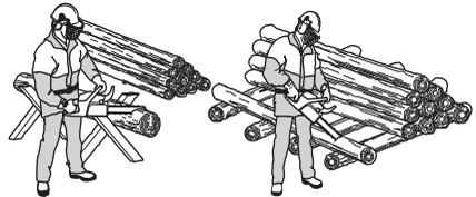
**Der Stamm liegt auf dem Erdboden.** Es besteht keine Gefahr, dass die Sägekette festklemmt oder der Baumstamm bricht. Es besteht jedoch die Gefahr, dass die Sägekette nach dem Durchsägen den Erdboden berührt.
