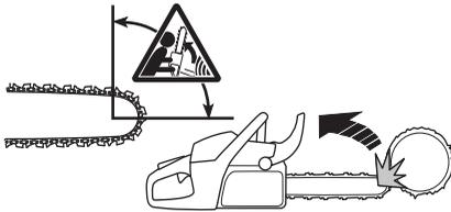
Žaganje s spodnjim robom meča, to se pravi od zgoraj navzdol, se imenuje žaganje na vlek. V tem primeru žago vleče proti deblu, njeno težo pa nosi spodnji rob meča. Ta način žaganja omogoča uporabniku boljši nadzor žage in položaja odbojnega območja meča.
