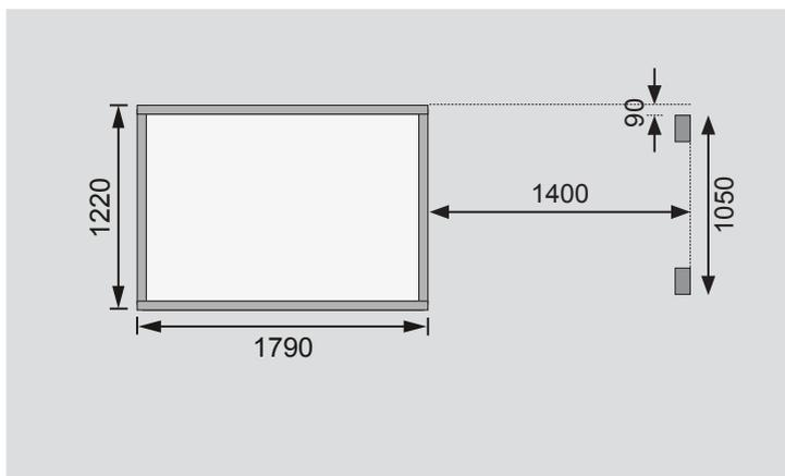
Fundamentplan mit Boden (in mm)
