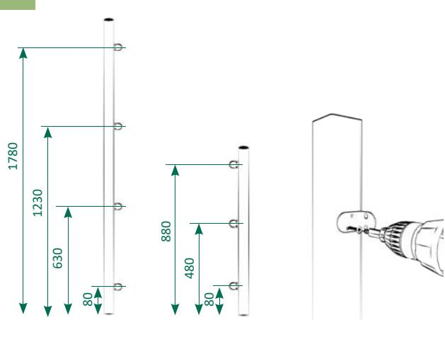
3 | Die Elementhalter mit zwei selbst schneidenden Schrauben Ø 3,9 x 25 mm am Pfosten befestigen. Es wird empfohlen, die Schraubenlöcher mit einem 3,3 mm Bohrer vorzubohren! Die Halter entsprechend der Maßangaben montieren.
