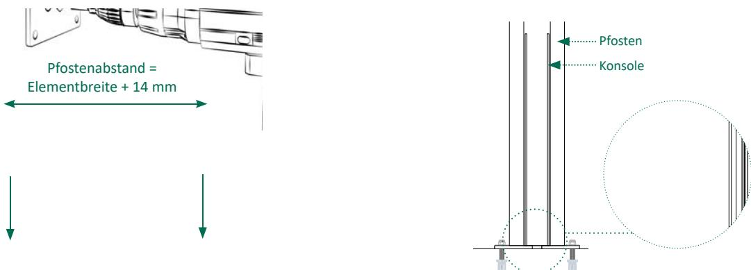
2a | Ausrichtung der Konsolen bei aufgesteckten Pfosten, danach aufdübeln\*.
