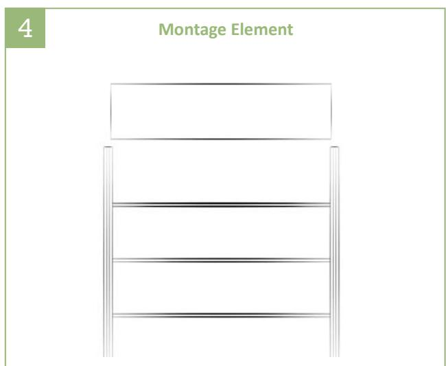
4 | Nach der Befestigung aller Elementhalter wird das Zaunelement mit jeweils zwei selbst schneidenden Schrauben Ø 3,9 x 19 mm pro Elementhalter rückseitig befestigt. Bitte vorbohren!
