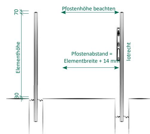
1 | Größe der Fundamente mindestens 300 x 300 x 800 mm sowie unter Berücksichtigung der Bodenbeschaffenheit.\* Ungefähr die Hälfte des Erdloches mit Beton füllen und verdichten. Anschließend die Pfosten setzen und ausrichten. Das Erdloch komplett mit Beton füllen und verdichten.
