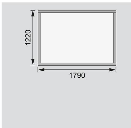
Fundamentplan mit Boden (in mm)
