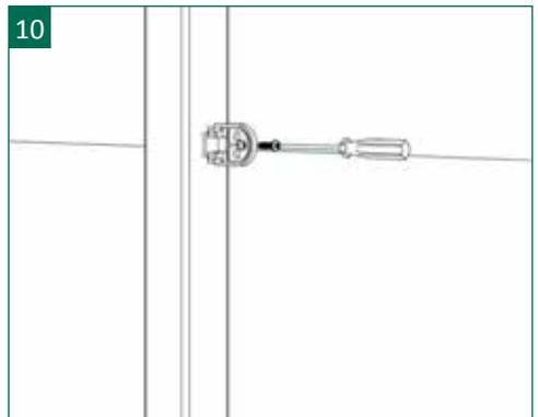
10 | Die Klemmplatten mit den beiliegenden Linsen-Blechschräuben 6,3 x 22 mm mit einem Kreuzschlitzschraubendreher an den Pfosten befestigen!
