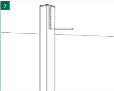
7 | Mit einem Stift werden die Schraubenlöcher für die Edelstahlklembacken markiert. Die Montagehöhen sind der Übersichtszeichnung der GroJaPremo Elemente zu entnehmen.
