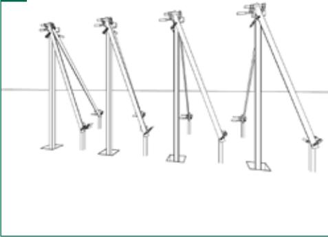
3 | Die Pfosten mit Holzleisten und Schraubzwingen zum nachfolgenden Einbetonieren abstützen. Zwischen Schraubzwinge und Kunststoffoberfläche kleine Hölzer legen, um Kratzer zu vermeiden! Nochmalige Kontrolle des korrekten Pfostenabstands und der senkrechten Ausrichtung!
