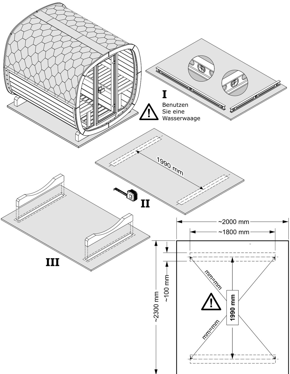
**Wir empfehlen ein vollflächiges Fundament: 2000 x 2300 mm**
