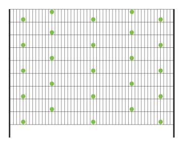
Die Distanzhalter werden um die senkrechten Stäbe gehakt, idealerweise nahe der Kreuzungspunkte. Dies beugt einem Ausbeulen der Matten durch die schwere Steinbefüllung vor.
