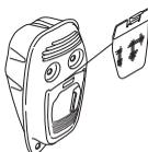
Na dušilcih brez katalizatorja je mrežico za lovljenje isker priporočljivo očistiti in po potrebi zamenjati enkrat na teden. Na dušilcih s katalizatorjem pregledajte in očistite mrežico za lovljenje isker enkrat na mesec. **Če je mrežica poškodovana, jo zamenjate.**
