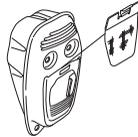
Bei Schalldämpfern ohne Katalysator sollte das Netz einmal in der Woche gereinigt und ggf. ausgetauscht werden. Bei Katalysatorschalldämpfern ist das Netz einmal im Monat zu kontrollieren und evtl. zu reinigen.
