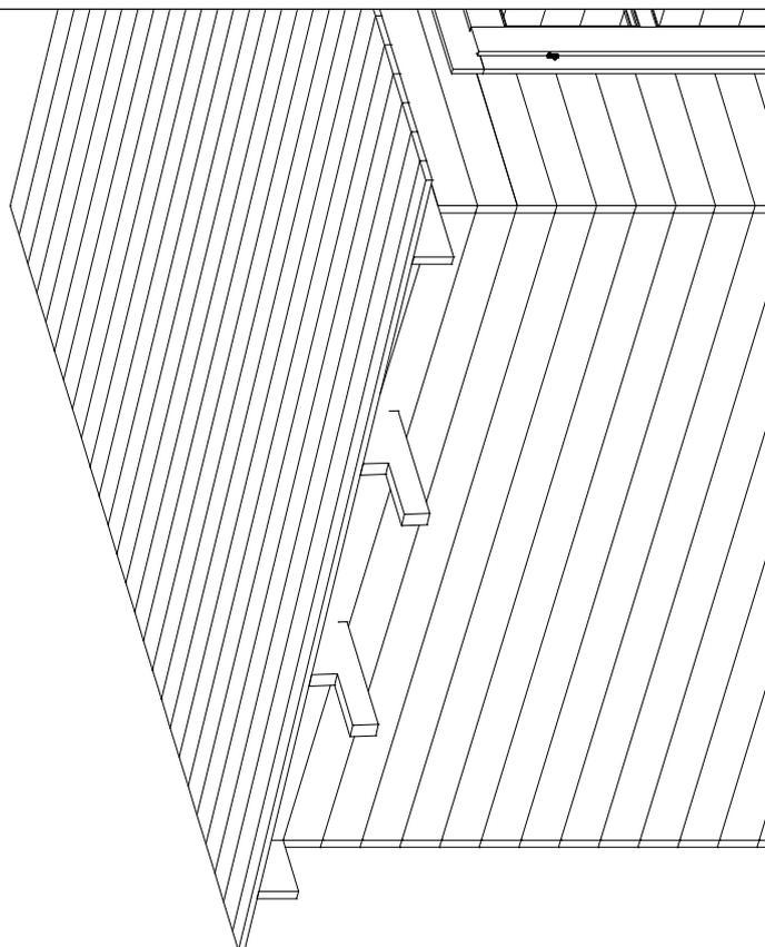
Falls kein Zubehör am Dach montiert werden soll, bitte die Enden der Dachbalken wie gezeigt absägen.
