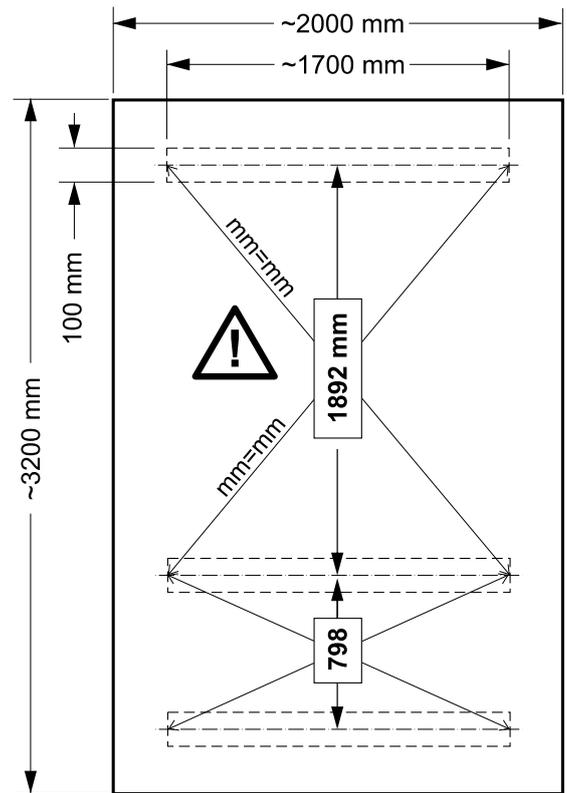
**Wir empfehlen ein vollflächiges Fundament: 2000 x 3200 mm**
