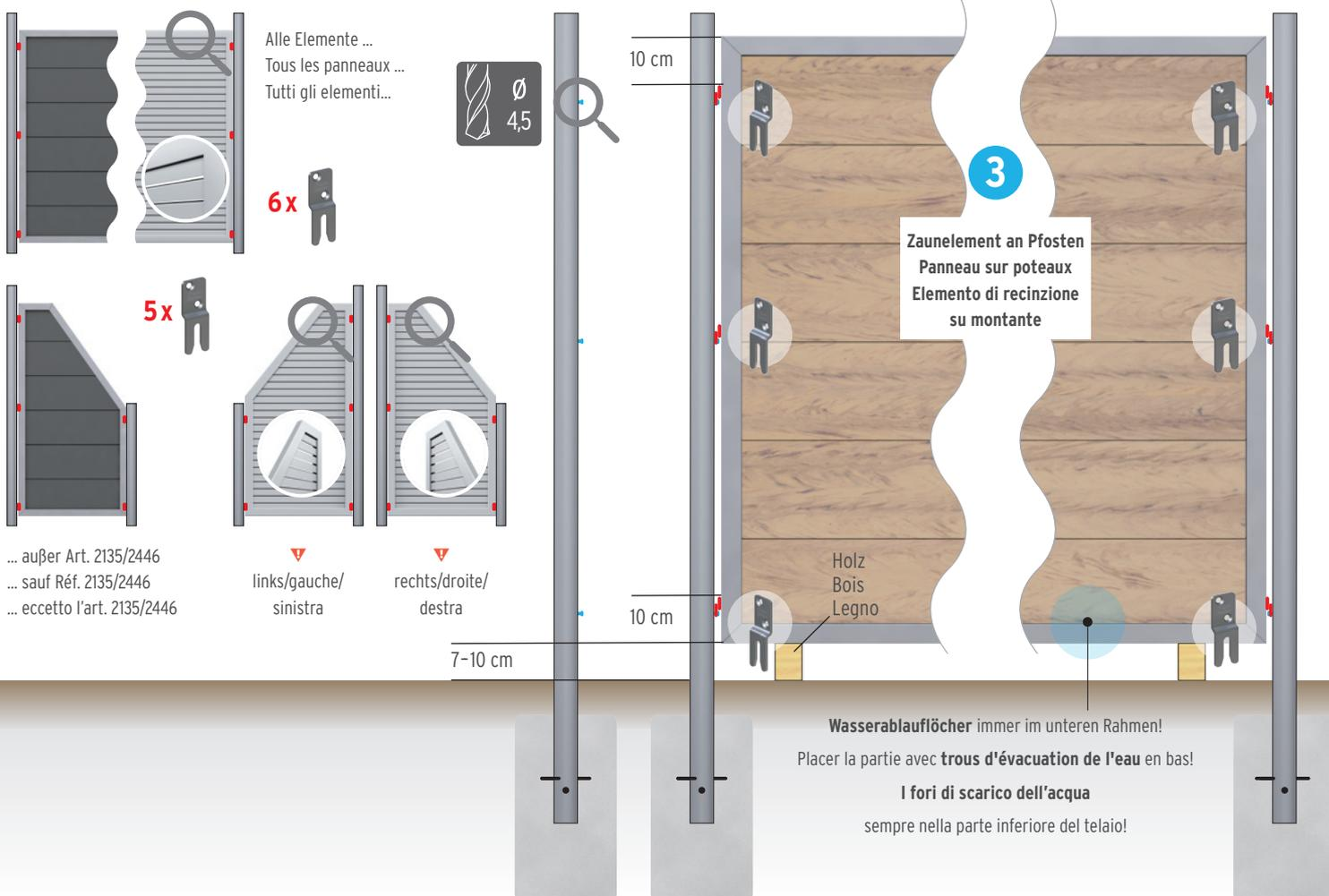
2 Fixez les panneaux uniquement avec le dispositif de fixation prévu (réf 2166). Important avant le montage de DESIGN RHOMBE: Harmonisez le sens des lamelles sur tous les panneaux en tournant les panneaux dans le même sens ▼!
