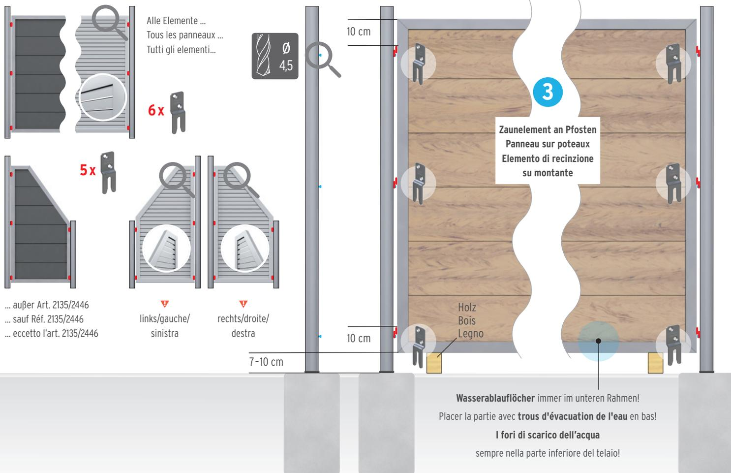
2 Fixez les panneaux uniquement avec le dispositif de fixation prévu (réf 2166). Important avant le montage de DESIGN RHOMBE: Harmonisez le sens des lamelles sur tous les panneaux en tournant les panneaux dans le même sens ▼!
