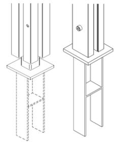
Sie müssen die Schrauben so fest anziehen, dass der innere Aluminium-Pfostenkern sich an den Stahlanker anschmiegt. Tipp: Geben Sie einen Tropfen Öl an die Verbindung Zylinderschraube / Vierkantmutter.
