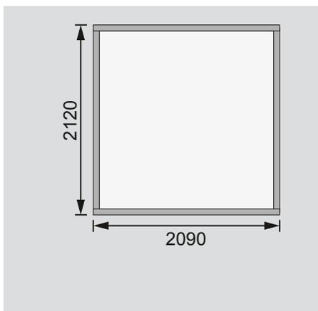
Fundamentplan mit Boden (in mm)
