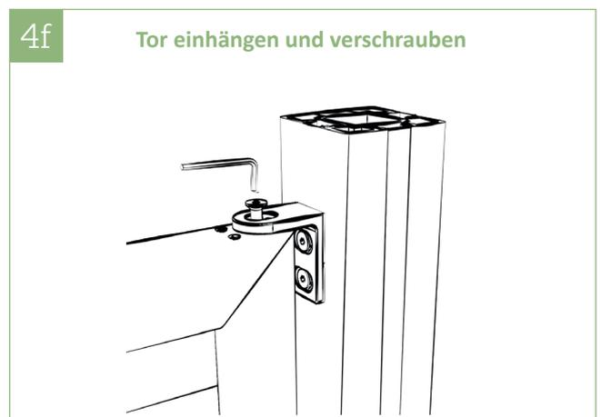
4f | Das Tor (Gehflügel) ausrichten und den oberen Lagerzapfen mittels Senkschraube befestigen.
