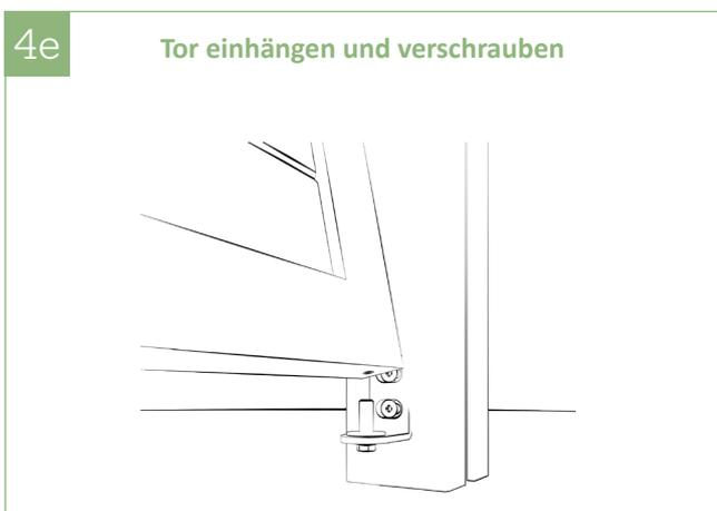
4e | Das Tor (Gehflügel) auf dem unteren Torlager positionieren
