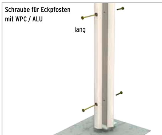
Bei Kombinationsanlagen, z. B. mit GLAS und WPC Elementen, die den Eckpfosten beiliegenden längeren Schrauben verwenden.
