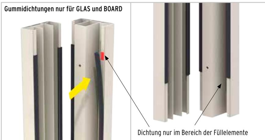
Für Glas und BOARD die diesen Artikeln beiliegenden Gummidichtungen aufstecken und punktuell an 3 Stellen mit doppelseitigem Kleband fixieren.
