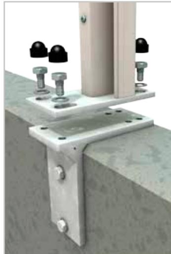
Mit dem Montageadapter können Sie eine SYSTEM Sichtschutzanlage auf eine Betonmauer setzen. Der Adapter passt zum aufschraubbaren SYSTEM Pfosten-träger. Mitgeliefert werden die Schrauben, Unterlegscheiben und Abdeckkappen für die Verbindung dieser beiden Elemente.
