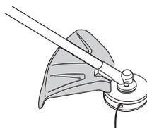
Controleer of de beschermkap niet beschadigd is en geen barsten vertoont. Vervang de beschermkap als ze gebarsten is of slagen te verduren gehad heeft.
