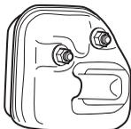
In Ländern mit warmem, trockenem Klima besteht erhöhte Brandgefahr. Bestimmte Schalldämpfer haben wir deshalb mit einem sog. Funken-fängernetz ausgestattet. Kontrollieren Sie, ob der Schalldämpfer Ihres Geräts ein solches Netz hat.
