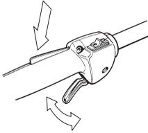
Siehe die Anweisungen unter der Überschrift Start. Gerät starten und Vollgas geben. Den Gashebel loslassen und kontrollieren, ob die Schneidausrüstung völlig zum Stillstand kommt. Wenn die Schneidausrüstung rotiert, während sich der Gashebel in Leerlaufstellung befindet, ist die LeerlaufEinstellung des Vergasers zu kontrollieren. Siehe die Anweisungen unter der Überschrift Wartung.
