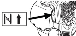
**Brandstofpomp:** Druk een aantal malen op de rubberen balg van de brandstofpomp totdat er brandstof in de balg komt. De balg hoeft niet helemaal gevuld te worden.
