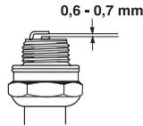
**ACHTUNG!** Stets den vom Hersteller empfohlenen Zündkerzentyp verwenden! Eine ungeeignete Zündkerze kann Kolben und Zylinder zerstören. Dafür sorgen, dass die Zündkerze eine sog. Funkenstörung hat.
