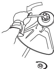
De nylon borging van de borgmoer mag niet zo versleten zijn dat ze met de vingers vast- of losgeschroefd kan worden. De borging moet ten minste 1,5 Nm houden. De moer moet vervangen worden nadat ze ca. 10 keer los en vast is geschroefd.
