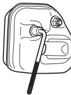
Si le silencieux comporte une grille antifleme, la nettoyer régulièrement. Une grille colmatée résulte en un échauffement du moteur pouvant donner lieu à de graves avaries du moteur.
