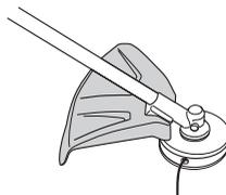
S'assurer que la protection est intacte et qu'elle ne présente pas de fissures. Remplacer la protection si elle a subi des coups ou si elle présente des fissures.
