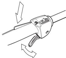
Voir le chapitre Démarrage. Démarrer la machine et donner les pleins gaz. Relâcher l'accélérateur et s'assurer que l'équipement de coupe s'arrête et qu'il reste immobile. Si l'équipement de coupe tourne lorsque l'accélérateur est au régime de ralenti, contrôler le réglage du ralenti du carburateur. Voir le chapitre Entretien.
