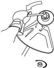
Die Nylonsicherung der Mutter darf nicht so abgenutzt sein, dass sie sich von Hand schrauben lässt. Die Sicherung soll mindestens 1,5 Nm halten. Nachdem sie ca. 10 Mal aufgeschraubt worden ist, ist die Mutter auszutauschen.
