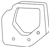
Un filtre ayant servi longtemps ne peut plus être complètement nettoyé. Le filtre à air doit donc être remplacé à intervalles réguliers. **Tout filtre endommagé doit être remplacé immédiatement.**
