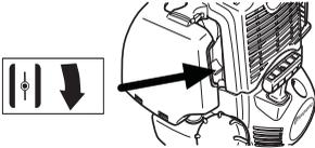
**Kraftstoffpumpe:** Mehrmals auf die Gummibläse der Kraftstoffpumpe drücken, bis diese sich mit Kraftstoff zu füllen beginnt. Die Blase braucht nicht ganz gefüllt zu werden.
