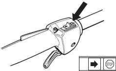
Den Motor starten und kontrollieren, ob der Motor stoppt, wenn der Stoppschalter in Stoppstellung geführt wird.
