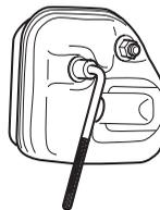
Ist der Schalldämpfer Ihres Gerätes mit einem Funkenfangnetz versehen, muss dieses regelmäßig gereinigt werden. Ein verstopftes Netz verursacht ein Heißlaufen des Motors mit schweren Motorschäden als Folge.
