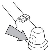
En général, il n'est pas nécessaire de remplacer le lubrifiant du carter, sauf en cas de réparations.
