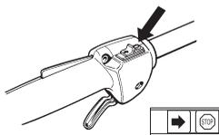
Start de motor en controleer of de motor wordt uitgeschakeld wanneer de stopschakelaar in de stopstand wordt gezet.
