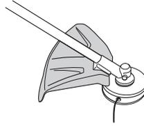
Den Schutz auf Schäden und Risse kontrollieren. Den Schutz austauschen, wenn er Schlägen ausgesetzt war oder Risse aufweist.
