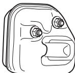
Le risque d'incendie est important dans les pays au climat chaud et sec. C'est pourquoi nous avons équipé certains silencieux de grilles antifleme. Vérifier si le silencieux de la machine est muni d'un tel dispositif.
