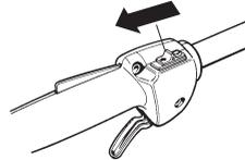
**Choke:** Zet de choke-hendel in de choke-positie.
