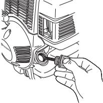
Bei niedrigem Ölstand Motoröl bis zur Kante des Öleinfülldeckels einfüllen.
