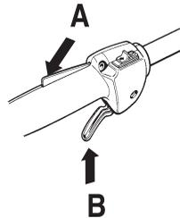
Kontrollieren, ob der Gashebel in Leerlaufstellung gesichert ist, wenn sich die Gashebelsperre in Ausgangsstellung befindet.
