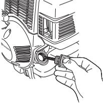
Si le niveau d'huile est bas, remplir d'huile moteur jusqu'au bord du trou de remplissage d'huile.
