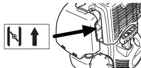
**Pompe à carburant:** Appuyer sur la poche en caoutchouc de la pompe à carburant plusieurs fois jusqu'à ce que le carburant commence à remplir la poche. Il n'est pas nécessaire de remplir la poche complètement.
