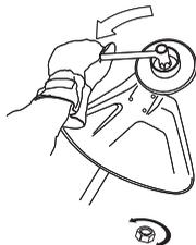
L'usure du verrouillage nylon du contre-écrou ne doit pas être telle qu'il peut se visser à l'aide des doigts. Le verrouillage doit résister à 1,5 Nm au moins. Remplacer le contre-écrou après une dizaine de serrages.
