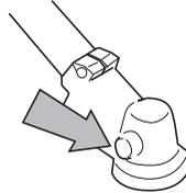
Das Schmiermittel im Getriebegehäuse braucht normalerweise nur bei evtl. Reparaturen gewechselt zu werden.
