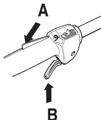
Vérifier d'abord que la commande de l'accélération est bloquée en position de ralenti quand le blocage de l'accélération est en position initiale.
