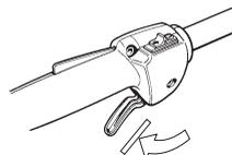
Die Gashebelsperre eindrücken und kontrollieren, ob sie in die Ausgangsstellung zurückkehrt, wenn sie losgelassen wird.
