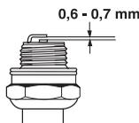
**REMARQUE!** Toujours utiliser le type de bougie recommandé! Une bougie incorrecte peut endommager le piston/le cylindre. S'assurer que la bougie est dotée d'un antiparasites.
