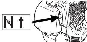
**Kraftstoffpumpe:** Mehrmals auf die Gummiblase der Kraftstoffpumpe drücken, bis diese sich mit Kraftstoff zu füllen beginnt. Die Blase braucht nicht ganz gefüllt zu werden.
