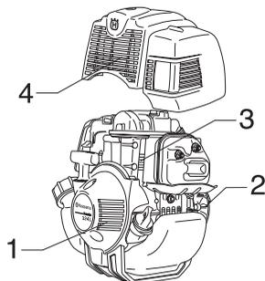
Le système de refroidissement est composé des éléments suivants:
