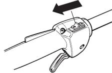
**Choke:** Den Chokehebel in Choke-Lage führen.
