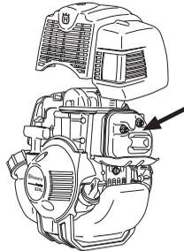
Wenn der Schalldämpfer Ihres Geräts mit einem Funkenfängernetz ausgestattet ist, so ist dieses regelmäßig zu reinigen. Bei Verstopfung des Netzes läuft der Motor heiß, was schwere Motorschäden zur Folge haben kann.
