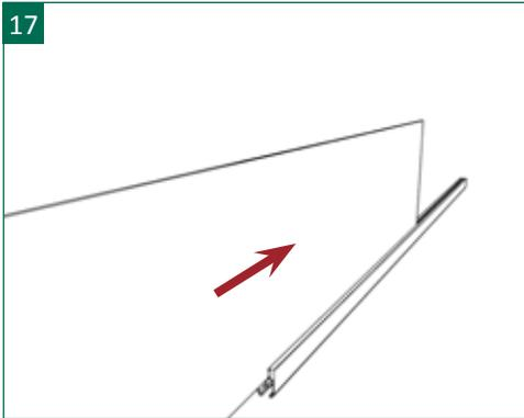
17 | Optional kann ein Designelement (Glas- oder Lochblecheinsatz) in zwei verschiedenen Größen (150 und 300 mm) eingefügt werden. Dieses wird anstelle von einem bzw. zwei Füllungsprofilen eingebracht. Hierzu das Designelement zuerst in die Nut der unteren Aluminium-Adapterleiste zwischen die Bürstendichtungen von der Seite einschieben.
