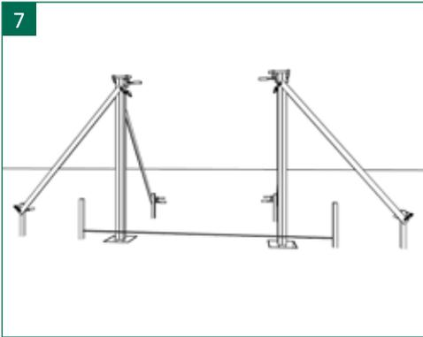
7 | Die Pfosten mit Holzleisten und Schraubzwin- gen zum nachfolgenden Einbetonieren abstützen. Zwischen Schraubzwin- ge und Pfostenoberfläche kleine Hölzer legen, um Kratzer zu vermeiden! Nochmalige Kontrolle des korrekten Pfostenab- standes und der senkrechten Ausrichtung!
