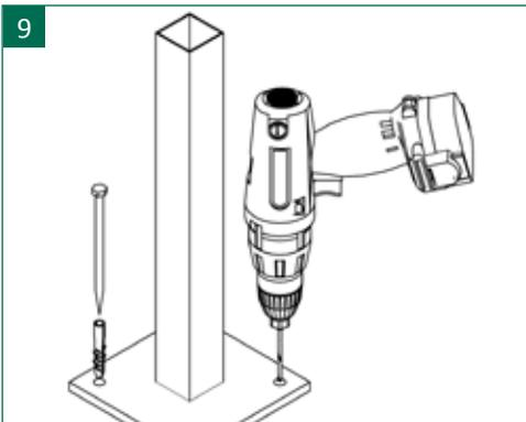
9 | Alternativ können bei bauseits vorhandenem Betonfundament oder Mauersockel Konsolen zum Aufschrauben Verwendung finden. Diese werden vom Maß her identisch wie beim Betonieren ausgerichtet und mit einer geeigneten Schrauben-/Dübelkombination befestigt.
