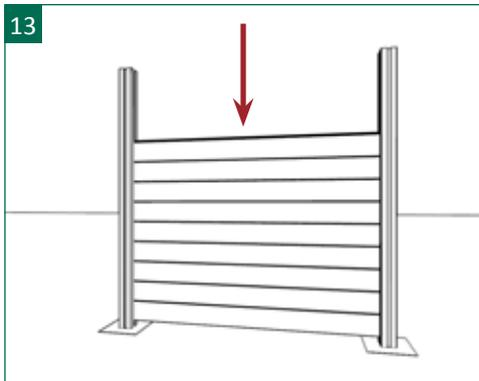
13 | Die weiteren Füllungsprofile werden nacheinander von oben eingeschoben. Die Nuten der Füllungsprofile sind hierbei nach unten gerichtet und greifen in die Feder des vorigen Profils ein. Ein 1800 mm hohes Zaunelement besteht aus 12 übereinander gesteckten Füllungsprofilen. Optional besteht die Möglichkeit, ein bzw. zwei Füllungsprofile durch ein Designelement (Glas- oder Lochblech) zu ersetzen (siehe hierzu ab Bild 17 folgend).
