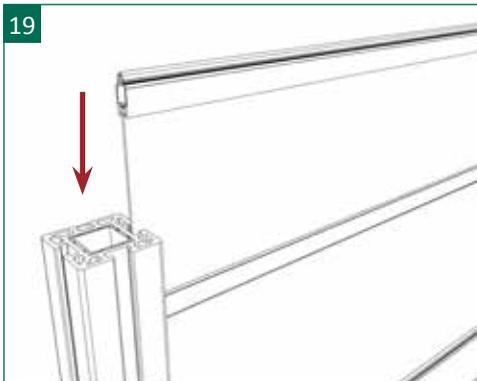
19 | Nun das Designelement mit den beiden Adapterleisten aus Aluminium zusammen vorsichtig zwischen die Pfostennuten einschieben und auf das untere Füllungsprofil aufschieben und einklicken.
