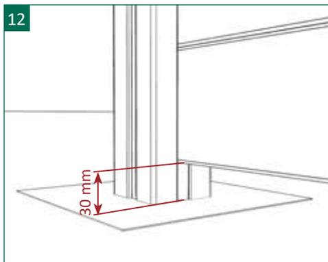
12 | Das unterste Füllungsprofil steht auf den Distanzstücken auf und erhält somit eine Bodenfreiheit von ca. 30 mm.
