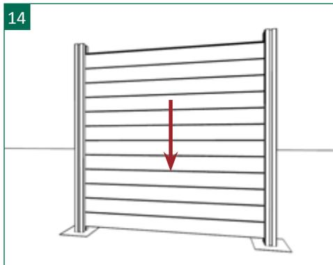
14 | Die Füllungsprofile werden anschließend bis auf eine maximale Höhe von 1800 mm aufeinandergesteckt.
