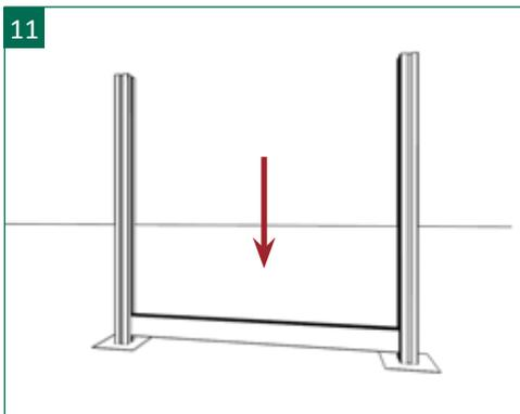
11 | Das erste Füllungsprofil wird von oben mittig zwischen den beiden Pfostennuten positioniert und bis auf die Distanzstücke heruntergedrückt. Die Feder des Nut- und Feder-Profiles ist hierbei nach oben gerichtet! Bitte achten Sie beim Einsetzen der Füllungsprofile auf ein einheitliches Erscheinungsbild der Oberfläche.
