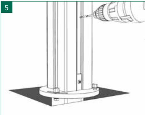
5 | Oberhalb des Distanzstückes empfehlen wir in die Nut auf zwei Seiten eine weitere Schraube mit einem Abstand von mind. 300 mm und max. 400 mm zu setzen. Hierbei ist darauf zu achten, dass der Kopf der Schraube in den Pfostenüberzug versenkt wird (die Schrauben sind nicht im Lieferumfang enthalten). Wir empfehlen, die Löcher mit einem 4 mm Metallbohrer vorzubohren.
