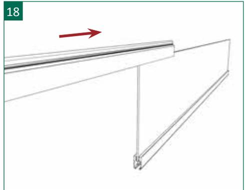
18 | Anschließend wird die obere Aluminium-Adapterleiste mit den Bürstendichtungen oben auf das Designelement von der Seite aufgeschoben.
