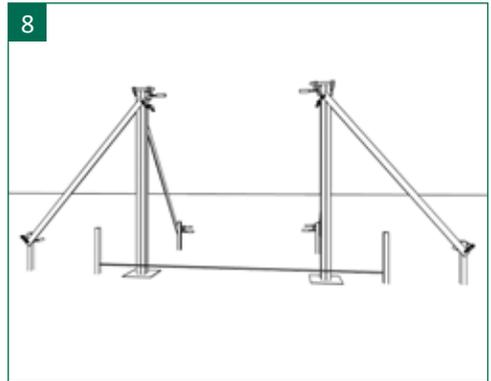
8 | Fertig- oder Estrichbeton in erdfeuchtem Zustand in die Erdlöcher füllen. Den Beton mit einem Kantholz verdichten! Zwischendurch immer wieder den korrekten Stand der Pfosten kontrollieren! Abschließend verbliebende Betonreste mit etwas Wasser von den Pfosten entfernen! Den Beton laut Packungsangabe (mind. 24 Std.) abbinden lassen. Die Pfosten bis zum Abbinden des Betons abstützen.
