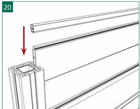
20 | Abschließend das oberste Füllungsprofil sowie das Aluminium-Abschlussprofil aufstecken. Aus Stabilitätsgründen ist über einem Designelement immer ein Füllungsprofil einzuplanen!
