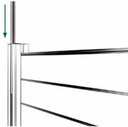
7 | Die Pfostenabdeckleisten von oben in die Pfostennut einschieben und mit der Unterkante des Pfostens bündig abschließen.
