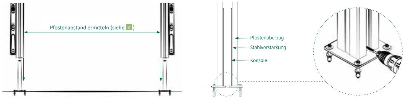
2a | Ausrichtung der Konsolen bei aufgesteckten Pfosten, danach aufdübeln. Der Pfostenüberzug und die Stahlverstärkung schließen nach dem Aufsetzen des Pfostens bündig ab.\*
