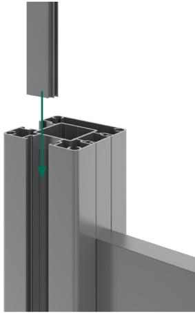
9 | Die Pfostenabdeckleisten von oben in die Pfostennut einschieben und mit der Unterkante des Pfostens bündig abschließen.
