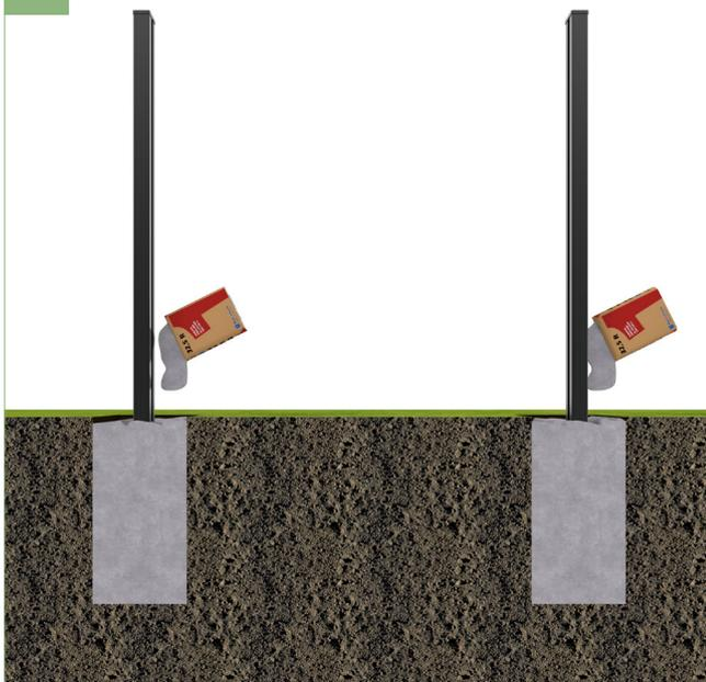
3 | Das Erdloch komplett mit Beton füllen und verdichten. Beton nach Herstellerangaben aushärten lassen.
