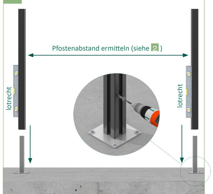
3a | Ausrichtung der Konsolen bei aufgesteckten Pfosten. Zum Befestigen der Konsolen auf den Untergrund die Pfosten entfernen. Zusätzlich kann der Pfosten durch eine Senkkopfschraube fixiert werden. Schrauben sind nicht im Lieferumfang enthalten.
