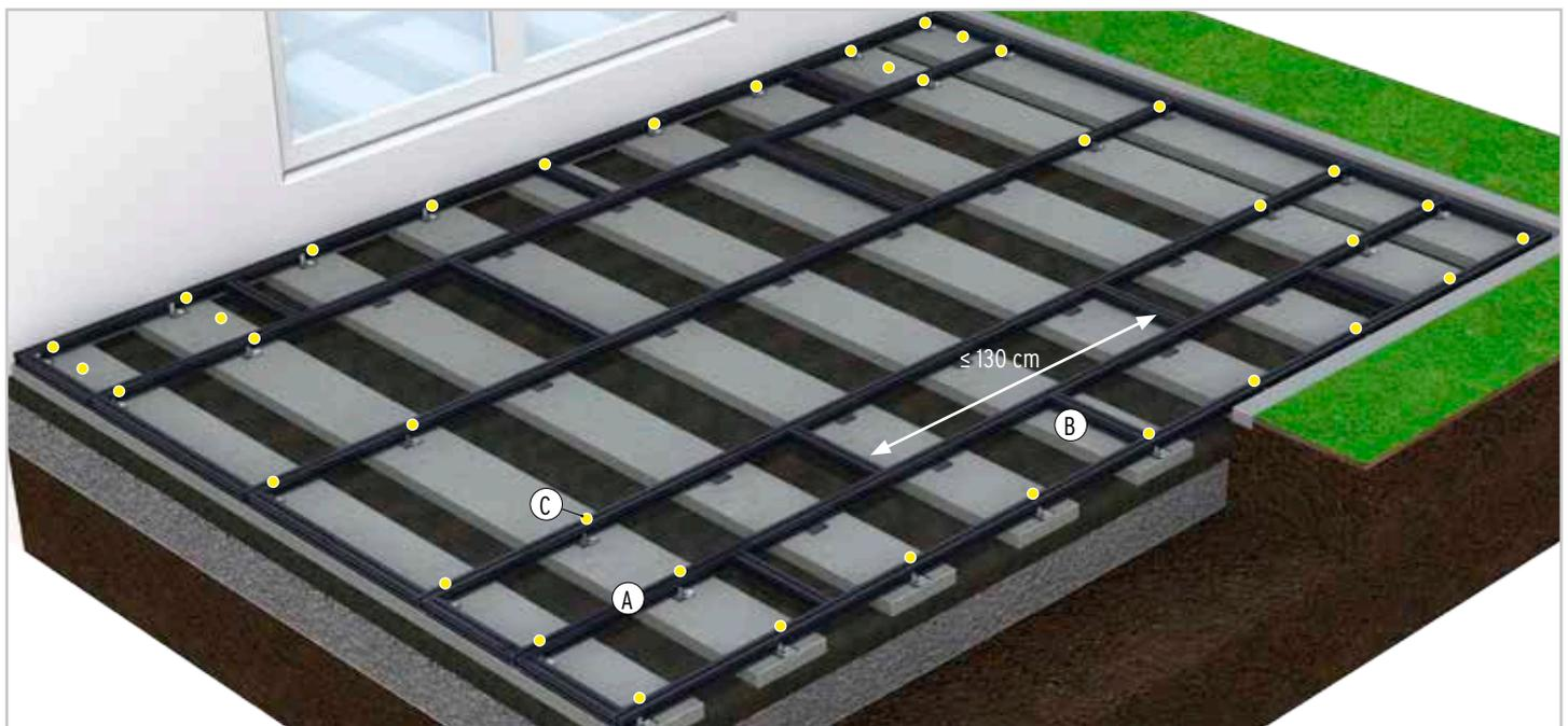
Der maximale Zwischenabstand bei der Unterkonstruktion beträgt 72 cm. An **Stellen mit höherer Belastung**, wie z. B. an Türen, an Antrittsstellen, bei Übergängen zu Treppen, bei der Platzierung von schweren Blumenkübeln oder Sonnenschirmen, **müssen Sie eine zusätzliche UK (A)** dazwischen montieren. Durch die zusätzliche Belastung oder das Gewicht darf die typische Materialausdehnung nicht verhindert werden.
