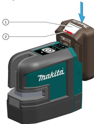
Ziehen Sie den Akku zum Abnehmen vom Werkzeug ab, während Sie den Knopf (1) an der Vorderseite des Akkus verschieben.
