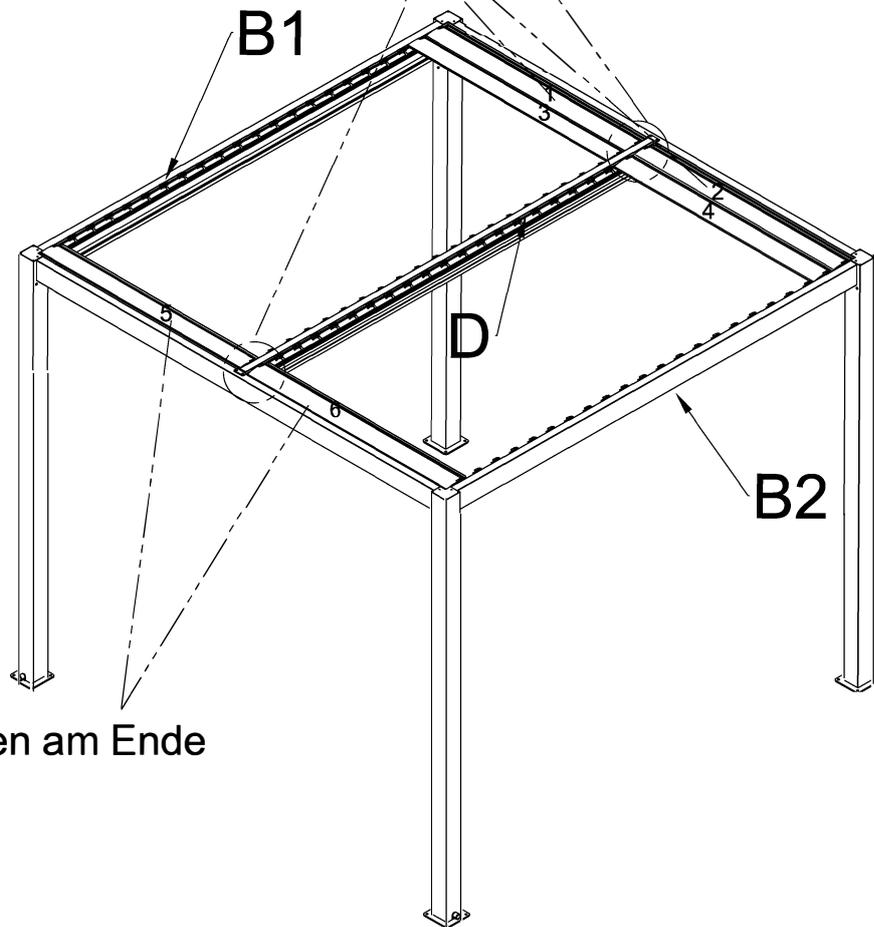
13. Ziehen Sie wie in Schritt 12, die Schrauben des Mittelträgers auf der Seite des Schwenkmechanismus an.
