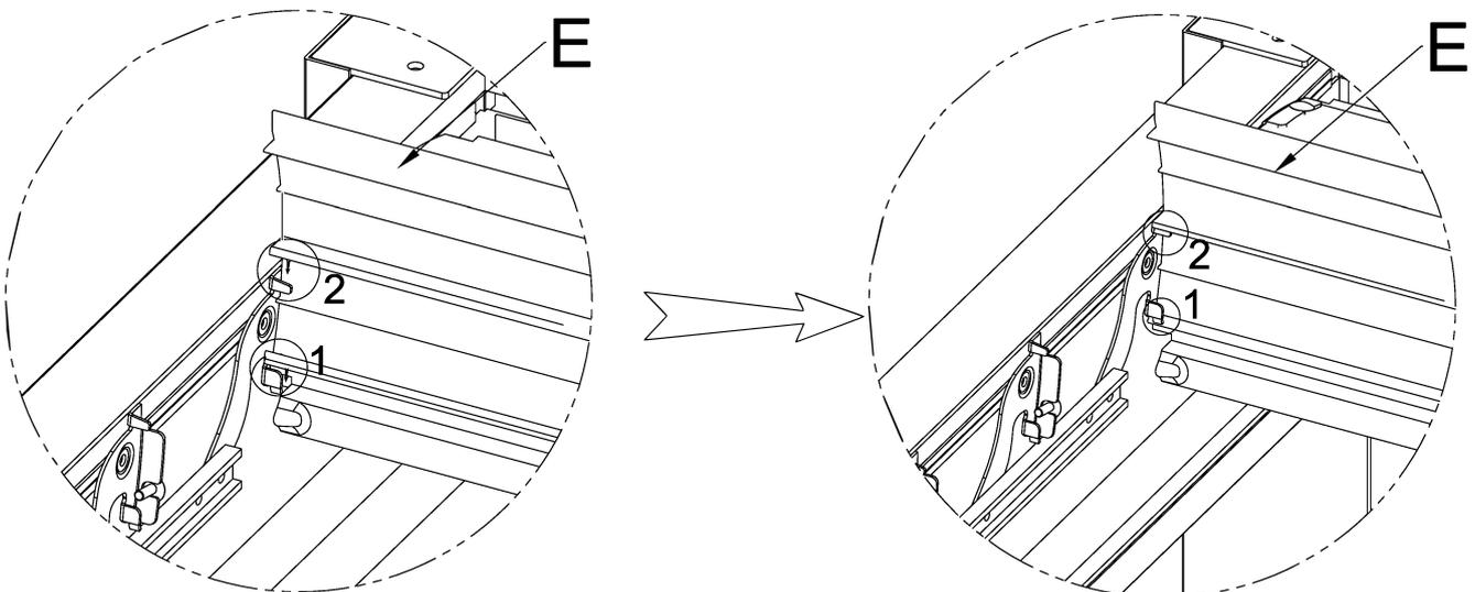
12.2 Nach der Montage der 6 Lamellen, überprüfen Sie, ob sich diese problemlos schwenken lassen.
