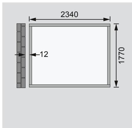
**Fundamentplan mit Boden (in mm)**
