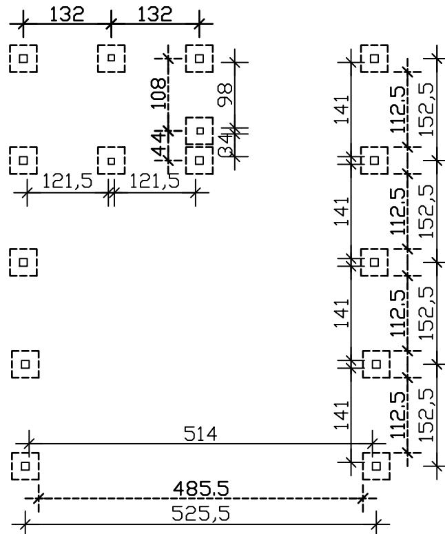
**Dachüberstände / Roof overhangs / Débords de toit / Dakoverstekken / střešní přesahy / Strešni previsi:****vorne / ahead / devant / vooruit / vpřed / predný:** 71cm**hinten / rear / arrière / achterkant / zadní / zadný:** 15cm**seitlich / side / côté / zijkant / boční / bokom:** 10cm
