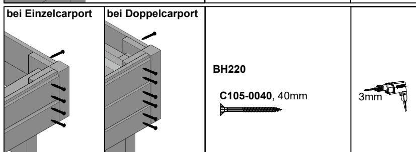
**Hinter wird aufgrund des Wasserablaufes keine Blende montiert.**
