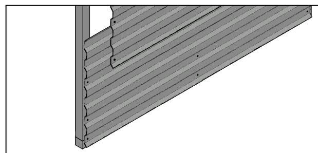
**DE:** Mitteln Sie die Platten aus und achten auf ein gleiches Wellenbild mit den anderen Elementen. Die obere Platte überlappt über der unteren Platte. Verschraubung zuerst am Ende der sichtbaren Überlappung, von da an nach oben und unten jede 2. Welle und am je letzten Wellental.
