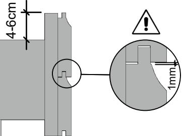
**Um den Profilschalbrettern bei feuchter Witterung Raum zum Quellen zu geben, muß zwischen den Brettern unbedingt ein Abstand von 1mm gelassen werden.**
