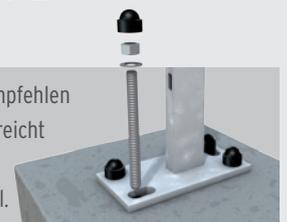
**f)** Nach der Aushärtung der Dübeltechnik bitte die Felder noch mal anheben und die Justierschrauben etwas eindrehen. Dann die Felder unter Spannung fest aufschieben.
