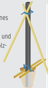
**d)** Stellen Sie alle Pfosten in die vorbereiteten Erdlöcher und hängen die Zaunfelder ein. Bitte die Justierschrauben so einstellen, dass sich die Elemente gut einhängen lassen.
