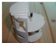
5. Platine in eine Gehäusehälfte einlegen. Einkerbung in der Fühlerplatte beachten.
