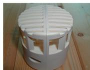
7. Die andere Gehäusehälfte seitlich auf die Befestigungsplatte und Platine schieben.
