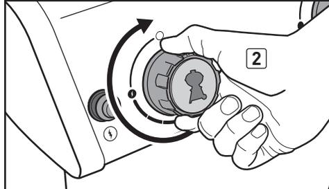
C) Öffnen Sie das Gasflaschenventil, wie es entsprechend des Reglertyps vorgesehen ist. Siehe Punkt "A." unter "PRÜFEN AUF GASLECKS".
