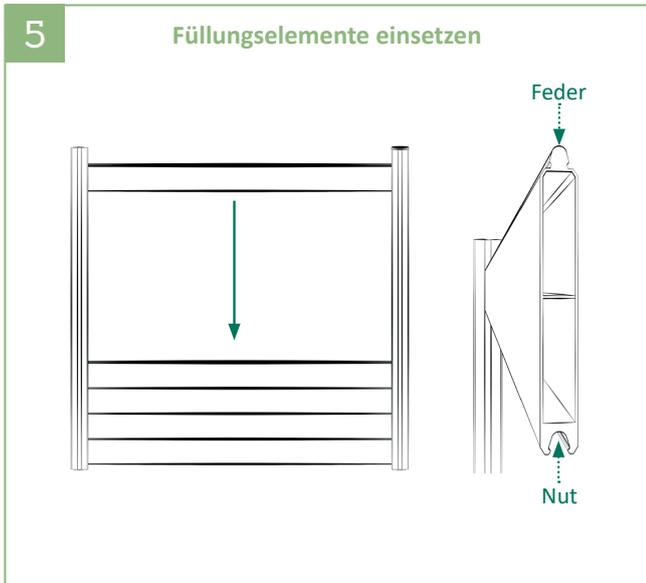
5 | Die Füllungselemente nacheinander von oben einschieben, dabei die Feder der Füllungselemente nach oben ausrichten.
