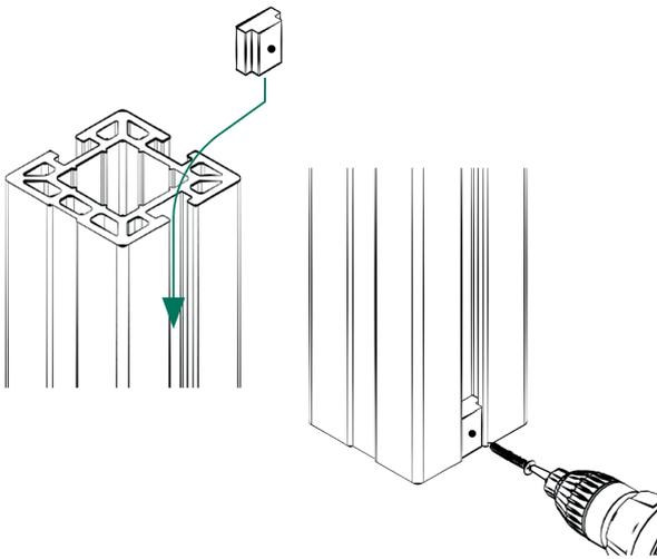
3 | Distanzstück hochkant in die Innenseite der Pfostennut einschieben, bündig mit der Unterkante des Pfostens abschließen, vorbohren und verschrauben.
