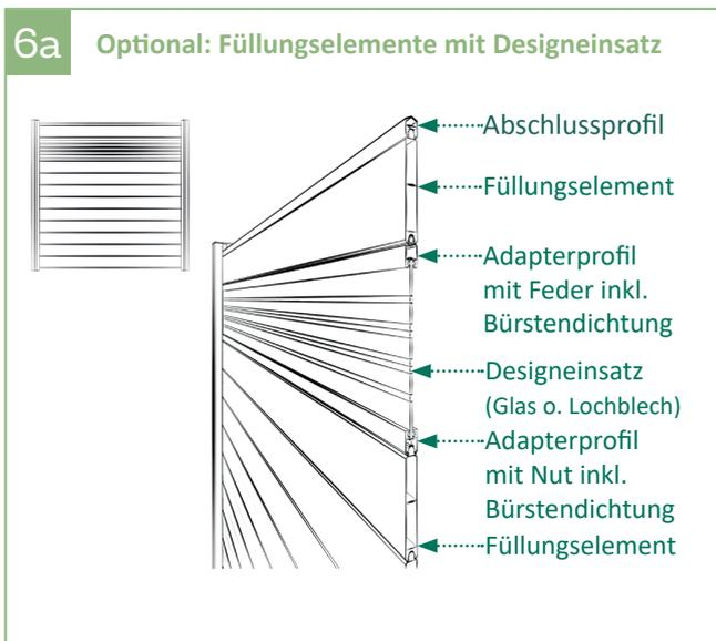
6a | Die Füllungselemente nacheinander von oben einschieben, dabei die Feder der Füllungselemente nach oben ausrichten. Bei der Montage des Designeinsatzes folgende Reihenfolge beachten: Adapterprofil mit Nut, Designelement, Adapterprofil mit Feder. Danach ein Füllungselement einschieben und das Abschlussprofil aufsetzen.
