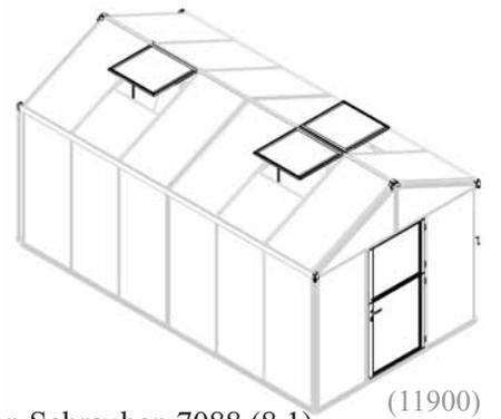
Befestigen Sie die in Schritt 6 montierten Türen am Türrahmen 7045 mit den Schrauben 7088 (8.1). Schieben Sie die Fenster von der Front-/Rückseite in das Firstprofil (8.2). Montieren Sie den Dachfensterfeststeller 7369 mit den selbstschneidenden Schrauben 7349 auf beiden Seiten des Dachfensters (8.3)(8.4).
