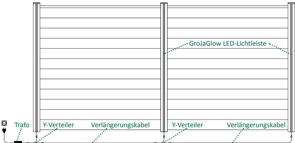
Die Komponenten der GroJaGlow LED-Lichtleiste wurden so entwickelt, dass Sie mit einer Steck-/Schraubverbindung verbaut werden. Die GroJaGlow LED-Lichtleisten werden über den Trafoanschluss ein- und ausgeschaltet. Um die GroJaGlow LED-Lichtleiste in die Hauselektrik einzubinden, sprechen Sie mit Ihrem Elektrofachmann.
