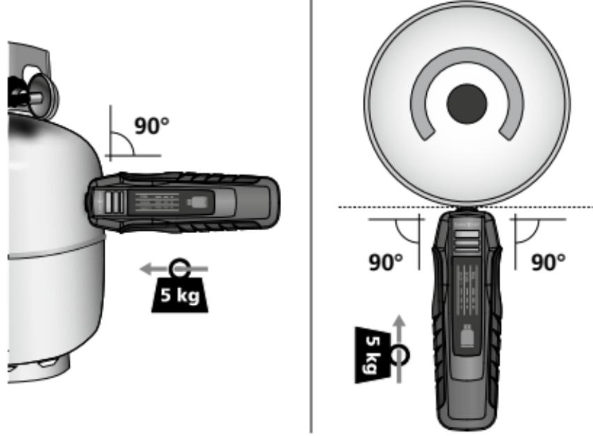
Colocar el cabezal de medición perpendicular sobre la superficie cilíndrica y presionarlo con una fuerza de aprox. 5 kg.
