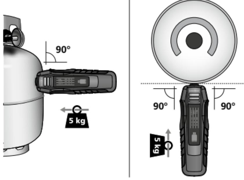
Appoggiare la testina di misura tenendola in verticale sulla superficie della bombola ed esercitare una pressione di contatto pari a 5 kg.
