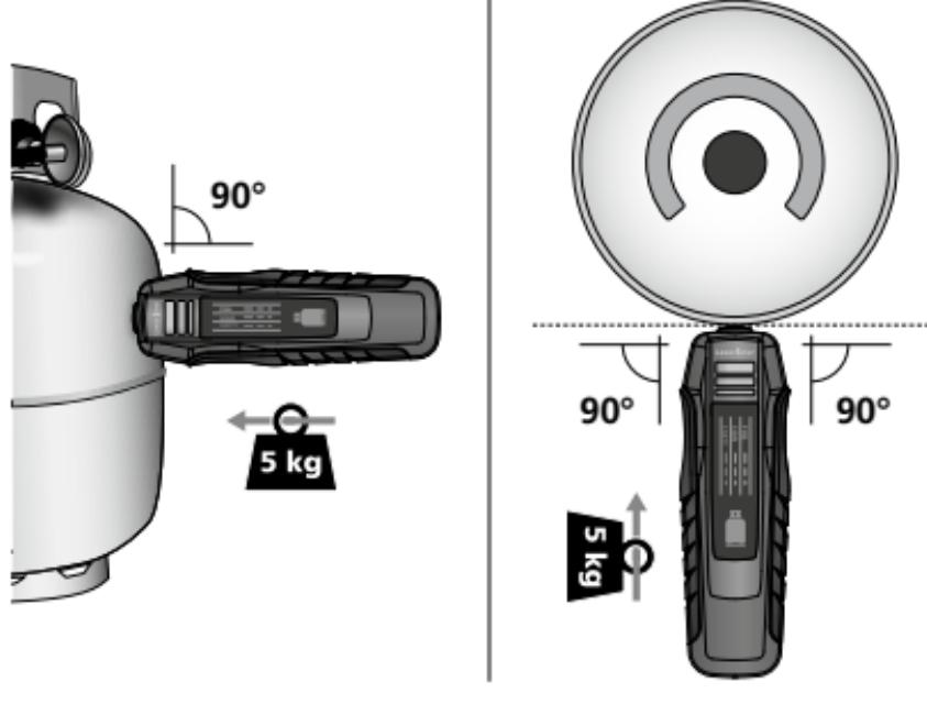
Den Messkopf senkrecht auf der Zylinderoberfläche auflegen und mit ca. 5 kg Anpressdruck andrücken.
