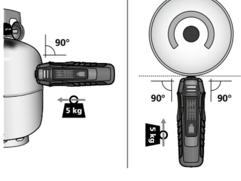
Głowicę pomiarową przyłożyć pionowo do powierzchni cylindrycznej i docisnąć siłą odpowiadającą ok. 5 kg.
