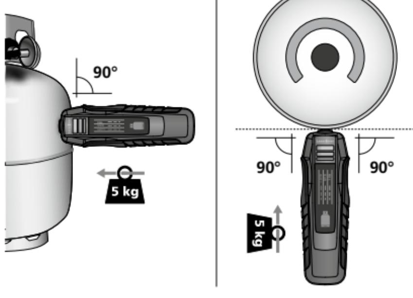
Placer målehovedet vinkelret på cylinderoverfladen og tryk på med ca. 5 kg kontakt tryk.
