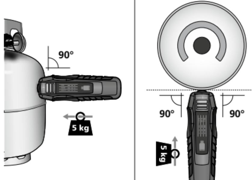
Plaats de meetkop verticaal op het cilinderoppervlak en druk hem aan met ongeveer 5 kg aanpersdruk.
