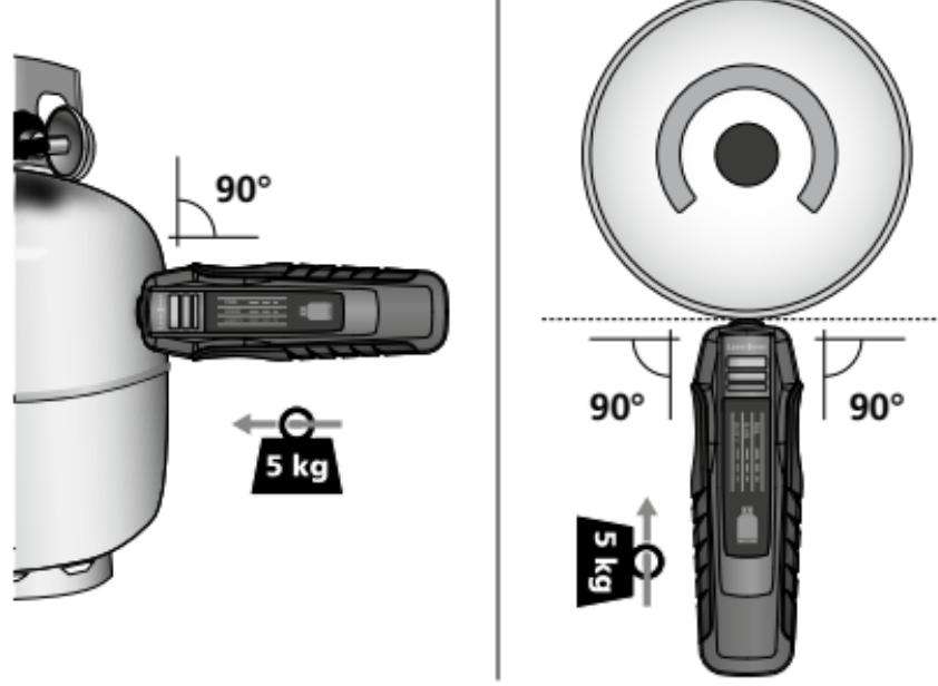
Ölçüm başlığını silindir yüzeyine dikey olarak yerleştirin ve yakla. 5 kg presleme basıncıyla üstüne bastırın.
