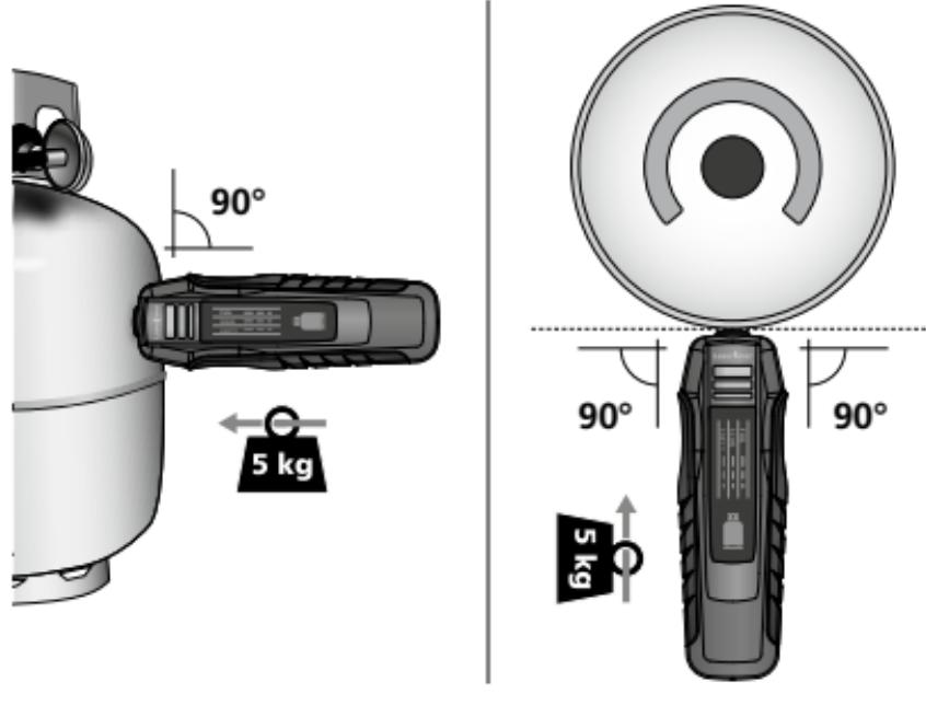
Colocar o cabeçote de medição na vertical, sobre a superfície do cilindro, e pressionar com aprox. 5 kg de pressão.
