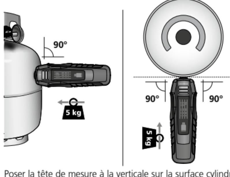
Poser la tête de mesure à la verticale sur la surface cylindrique et légèrement appuyer en appliquant une pression d'env. 5 kg. La barre de progression de la LED bleue signale une mesure en cours. Pendant cette opération, maintenir le scanner sans bouger et appuyé contre la bouteille de gaz.
