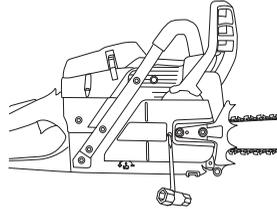
Die Kette ist richtig gespannt, wenn sie an der Schienenunterseite nicht durchhängt und noch leicht von Hand durchgezogen werden kann. Die Schienenspitze anheben und dabei gleichzeitig die Schienenmuttern mit dem Kombischlüssel festschrauben.
