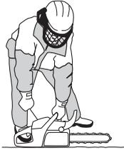
Halten Sie die Motorsäge mit festem Griff, in dem Sie die Handgriffe fest mit Daumen und Fingern umschließen.
