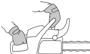
Poženite motor s polnim plinom in sprožite zavoro verige, tako da z levim zapetjem odsunete ščitnik odsunka. Pri tem ne
