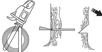
Der Fällschnitt soll parallel zur Kerbschnittlinie abschließen, so dass der Abstand zwischen beiden
