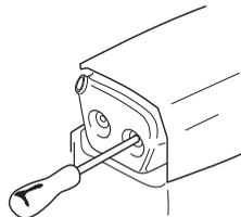
Bestimmte Schalldämpfer sind mit einem speziellen Funkenfangnetz ausgerüstet. Ist Ihr Gerät mit einem derartigen Schalldämpfer ausgestattet, so ist das Netz einmal wöchentlich zu säubern. Dies geschieht am besten mit einer Stahlbürste. Bei Verstopfung des Netzes läuft der Motor heiß, was schwere Motorschäden zur Folge haben kann.
