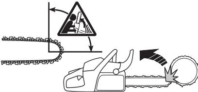
Ein Rückschlag ist immer in Richtung der Führungsschiene gerichtet. Am häufigsten erfolgt der Stoß von Motorsäge und Führungsschiene nach oben und nach hinten zum Anwender. Rückschläge erfolgen aber auch in andere Richtungen, je nachdem in welcher Stellung sich die Motorsäge in dem Augenblick befindet,
