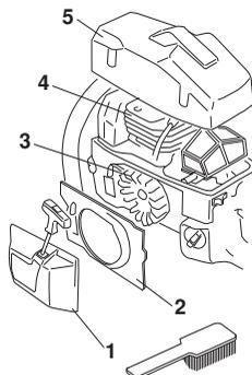
Hladilni sistem očistite s krtačo enkrat tedensko, v zahtevnih pogojih dela pa tudi pogosteje. Umazan ali zamašen hladilni sistem povzroča pregrevanje stroja, to pa poškoduje bat in cilindar.
