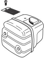
Der Schalldämpfer hat die Aufgabe, den Schallpegel zu dämpfen und die Abgase vom Anwender wegzuleiten. Die Abgase sind heiß und können Funken enthalten, die einen Brand verursachen können, wenn die Abgase auf trockenes und brennbares Material gerichtet werden.
