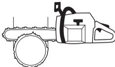
Es gibt Methoden zum Fällen von Bäumen, deren Stammdurchmesser größer ist als die Führungsschiene Länge. Bei solchen Methoden besteht große Gefahr, dass der Rückschlagbereich der Führungsschiene mit einem Gegenstand in Berührung kommt.
