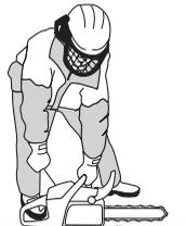
Takoj ko motor poskuša vžgati, potisnite ročico čoka navznoter, nato pa nadaljujte s poskusi, dokler motor ne vžge. Ko motor vžge, hitro dodajte polni plin; zagonski plin se samodejno izklopi.
