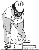
Sobald der Motor zündet, den Chokehebel einschieben und neue Startversuche machen, bis der Motor anspringt. Wenn der Motor anspringt, schnell Vollgas geben, und das Startgas schaltet sich automatisch aus.
