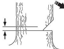
Die Rindenstütze (falls montiert) hinter der Brechmaß ansetzen. Mit Vollgas sägen und mit der Sägekette/Führungsschiene langsam in den Baumstamm schneiden. Aufpassen, ob sich der Baumstamm entgegengesetzt zur Fällrichtung bewegt. Einen Fällkeil oder einen Fällheber in den Fällschnitt schieben, sobald die Schnitttiefe dies gestattet.
