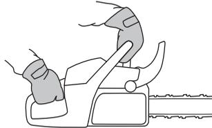
Geben Sie Vollgas und betätigen Sie die Kettenbremse, in dem Sie das linke Handgelenk gegen den Handschutz drehen. Lassen Sie den vorderen Handgriff nicht los. **Die Kette soll sofort stoppen.**
