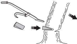
Wir empfehlen eine Führungsschiene Länge zu benutzen, die größer ist als der Stammdurchmesser, sodass Kerb- und Fällschnitt mit einem sog. einfachen Sägeschnitt ausgeführt werden können. Siehe die Anweisungen unter der Überschrift Technische Daten hinsichtlich der Schienenlängen, die für Ihr Motorsägenmodell empfohlen werden.
