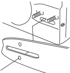
Verigo napnite s kombiniranim ključem tako, da obračate vijak za napenjanje verige v smeri urinega kazalca. Verigo napenjajte toliko časa, da ne bo več ohlapno visela s spodnjega roba meča. Glejte navodila pod naslovom Tesnjenje verige žage.
