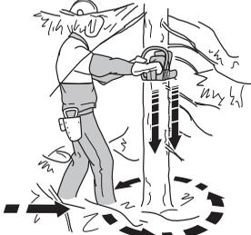
Unterholz rund um den Baum entfernen und auf evtl. Hindernisse achten (Steine, Äste, Löcher usw.), so dass ein leichter Rückzugsweg gesichert ist, wenn der Baum zu fallen beginnt. Der Rückzugsweg sollte etwa 135° schräg hinter der geplanten Fällrichtung des Baumes liegen.
