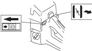
Wenn das Gerät mit Dekompressionsventil (A) ausgerüstet ist: Dekompressionsventil eindrücken, damit der Druck im Zylinder reduziert wird; dadurch wird das Anspringen erleichtert. Das Dekompressionsventil sollte beim Anlassen immer betätigt werden. Wenn die Maschine läuft, geht das Dekompressionsventil automatisch in Nullstellung zurück.
