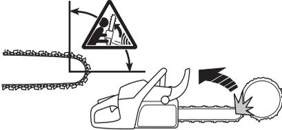
Das Sägen mit der Unterseite der Führungsschiene, d.h. von der Oberseite des Baumstammes nach unten, wird als Sägen mit ziehender Kette bezeichnet. Die Motorsäge wird zum Baumstamm hingezogen und die Vorderkante des Motorsägenkörpers fungiert als natürliche Stütze am Stamm. Beim Sägen mit ziehender Kette hat der Anwender eine bessere Kontrolle über die Motorsäge und über den Rückschlagbereich der Führungsschiene.
