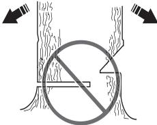
Wenn Kerb- und Fällschnitt ausgeführt sind, soll der Baum von selbst oder mit Hilfe von Fällkeil oder Fällheber fallen.
