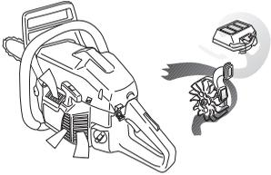
WICHTIG! Um die Funktion der Zentrifugalreinigung aufrecht zu erhalten, muss diese regelmäßig gewartet und gepflegt werden. Den Lufteinlass der Startvorrichtung, die Gebläseflügel des Schwungrads, den Raum um das Schwungrad, das Ansaugrohr und den Vergaserraum reinigen.
