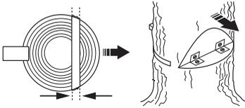
Man verliert völlig die Kontrolle über die Fallrichtung des Baumes, wenn das Brechmaß zu klein oder durchgesägt ist oder wenn Kerb- und Fällschnitt an falscher Stelle ausgeführt wurden.
