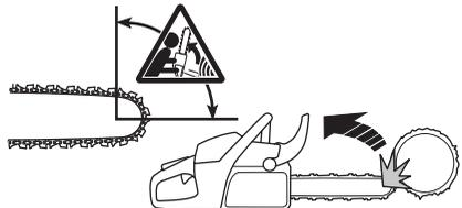
Žaganje s spodnjim robom meča, to se pravi od zgoraj navzdol, se imenuje žaganje na vlek. V tem primeru žago vleče proti deblu, njeno težo pa nosi spodnji rob meča. Ta
