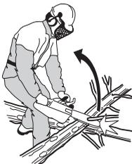
Das Werkstück stets beobachten. Sind die gesägten Abschnitte klein und leicht, können sie sich in der Sägekette verfangen und gegen den Bediener geschleudert werden. Auch wenn dies allein nicht immer gefährlich sein muss, können Sie überrascht werden und die Kontrolle über die Säge verlieren. Niemals gestapelte Stämme oder Äste sägen, sondern sie erst auseinander ziehen. Jeweils nur einen Stamm oder einen Abschnitt sägen. Die
