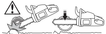
Wenn die Möglichkeit vorhanden ist (= kann der Stamm gedreht werden?), sollte der Stamm zu 2/3 durchgesägt werden.
