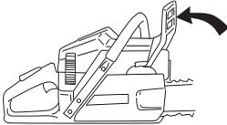
Die Schienenmuttern lösen und den Kupplungsdeckel (Kettenbremse) abnehmen. Den Transportschutz (A) entfernen.
