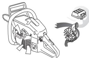
**POMEMBNO!** Učinkovitost centrifugalnega čiščenja je odvisna od rednega vzdrževanja in nege. Očistite dovod zraka v zaganjalnik, krila ventilatorja, prostor okrog ventilatorja, dovodno cev in komoro uplinjača.
