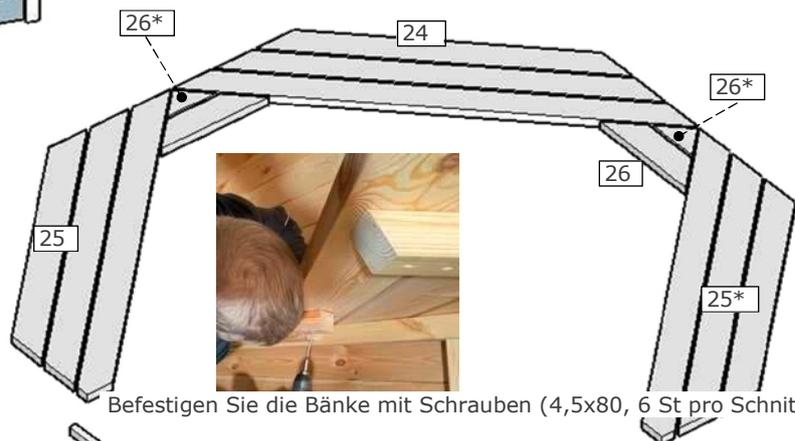
Befestigen Sie die Bänke mit Schrauben (4,5x80, 6 St pro Schnittstelle)
