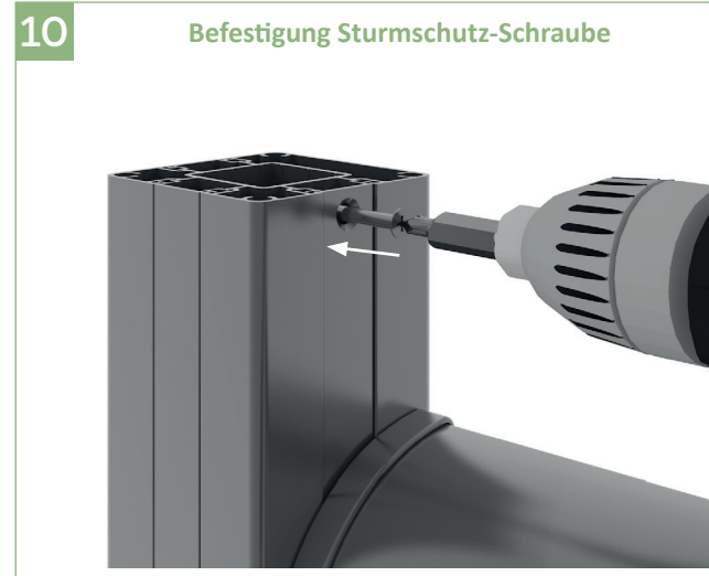
10 | Langes Distanzstück und Pfosten mit 3,5 mm Bohrer vorbohren. Mit einem Kegelsenker das Bohrloch senken. Die Sturmschutz-Schraube ST4,2 x 32mm am Pfosten befestigen.
