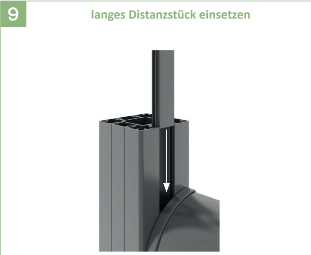
9 | Zum Schluss das lange Distanzstück nach Bedarf kürzen, von oben in den Pfosten einschieben.
