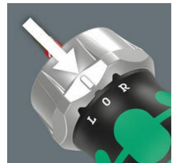
Die Ratschenmechanik ist feinverzahnt für einen geringen Rückholwinkel. Über den Umschaltring kann die Schraubrichtung rechts/fest/links vorgenommen werden. Die magnetische Bitaufnahme ist für Bits mit 1/4"-Außensechskantantrieb nach DIN ISO 1173-C 6,3 und Wera Anschluss-Reihe 1 geeignet.
