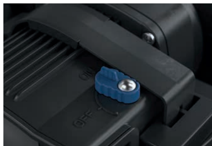
SFC-Schalter: Bei AquaMax Eco Premium 5000 - 21000. Bei eingeschalteter SFC-Funktion optimiert die Pumpe selbständig Wassermenge und Förderhöhe und reduziert diese um bis zu 50 %.
