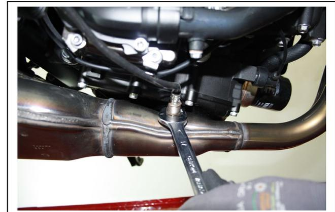
4. Lösen Sie nun die beiden Befestigungsschrauben des Endschalldämpfers unterm Motor. Lassen Sie jedoch die Schraube in Fahrtrichtung rechts noch montiert, so dass die Anlage später nicht herunterfallen kann.
