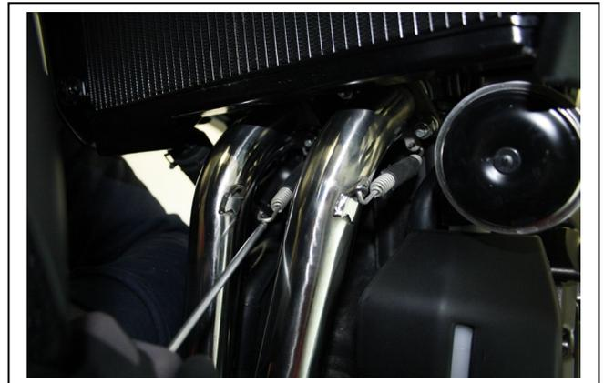
3. Hängen Sie dann 2 lange Zugfedern zwischen dem 2-1 Sammler und den Krümmern ein und drehen Sie die Lambdasonde ein.
